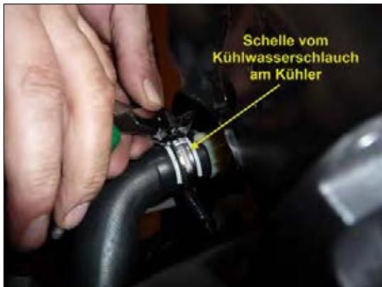
Bild 23: obere Kühlwasserschlauchschelle lösen
