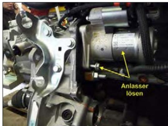
Bild 1: Anlasser demontieren
