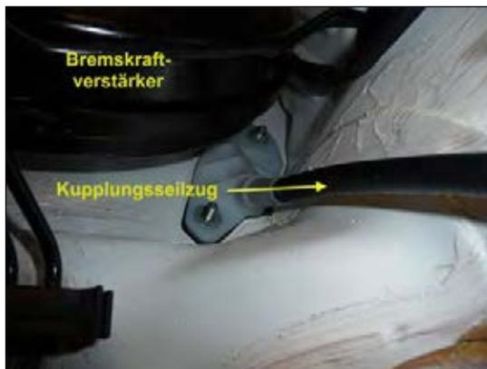
Bild 1: Muttern lösen
