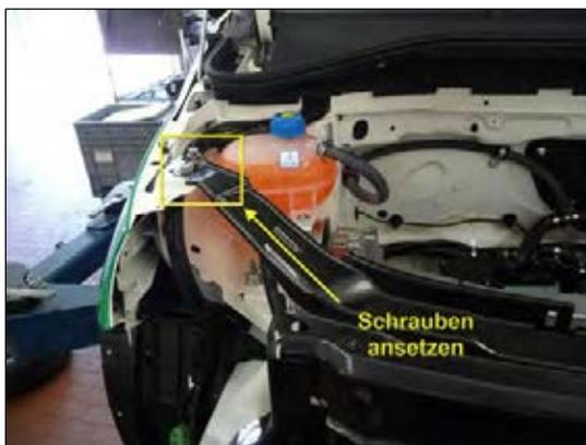
Bild 1: Fronttraverse ansetzen
