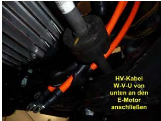
Bild 13: HV-Kabel „W“, „V“ & „U“ anschließen
