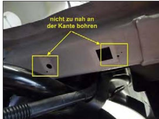
Bild 2: Bohrlöcher vorbohren
