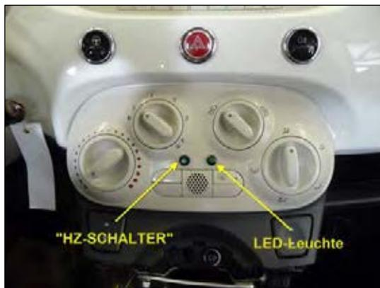
Bild 7: „HZ-SCHALTER“ & LED-Leuchte
