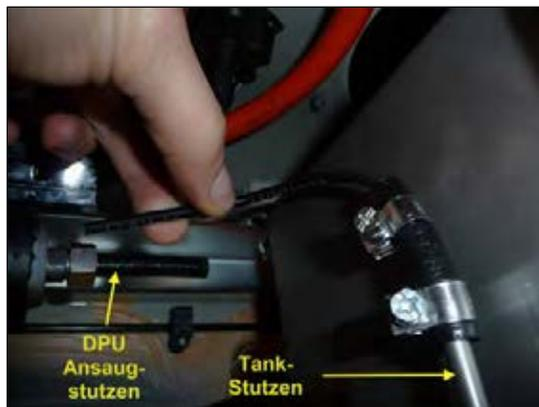
Bild 7: Kraftstoffleitung montieren
