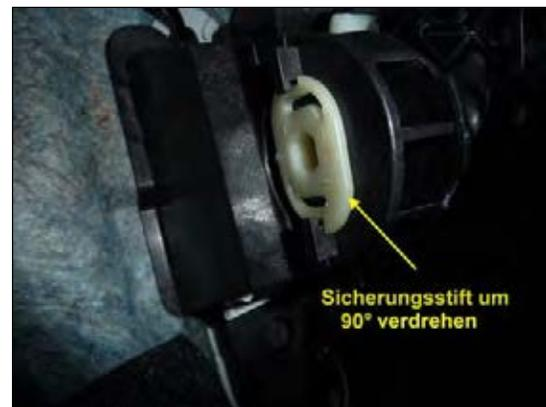
Bild 2: Sicherungstift entsichern
