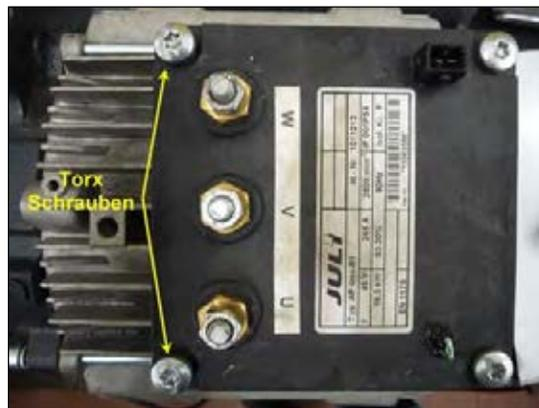
Bild 15: Torx-Schrauben lösen
