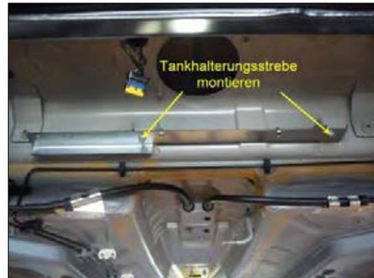
**Bild 2: Tankhalterstrebe montieren**
