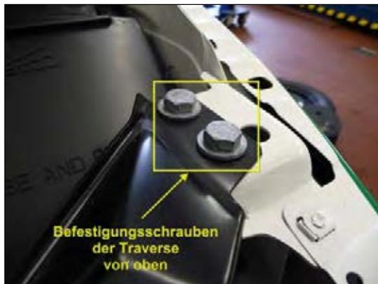
Bild 29: Fronttraverse demontieren
