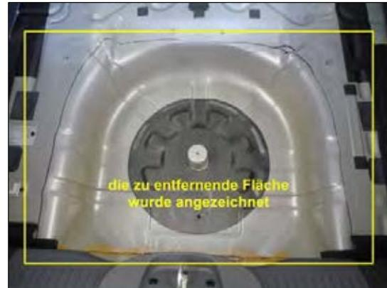
Bild 10: zu entfernende Fläche anzeichnen
