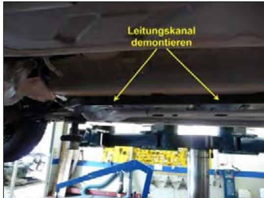
**Bild 7: Leitungskanal**
