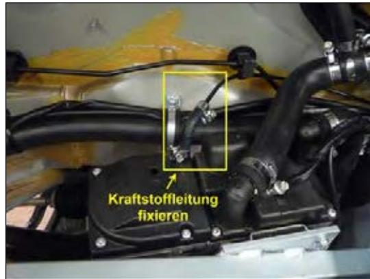
Bild 22: Kraftstoffleitung anschließen
