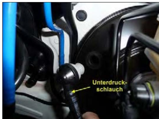
Bild 13: Unterdruckschlauch trennen
