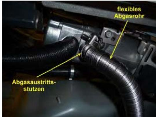
Bild 1: Montage des Abgasrohrs mit einer Schelle
