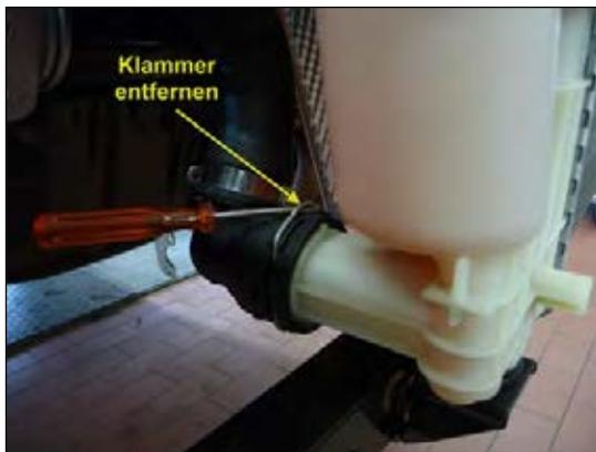
Bild 21: Demontage des Kühlwasserschlauchs
