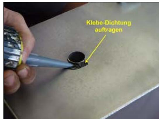
Bild 2: Klebe-Dichtung auftragen
