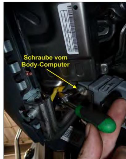
Bild 4: Body-Computer lösen
