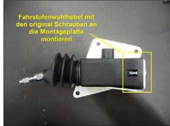
**Bild 4:** mit dem Halter montieren
