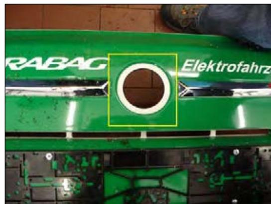
Bild 4: aufgebohrte Stoßstange
