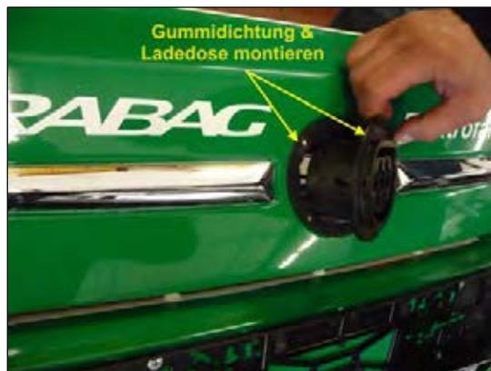
Bild 7: Ladedose montieren
