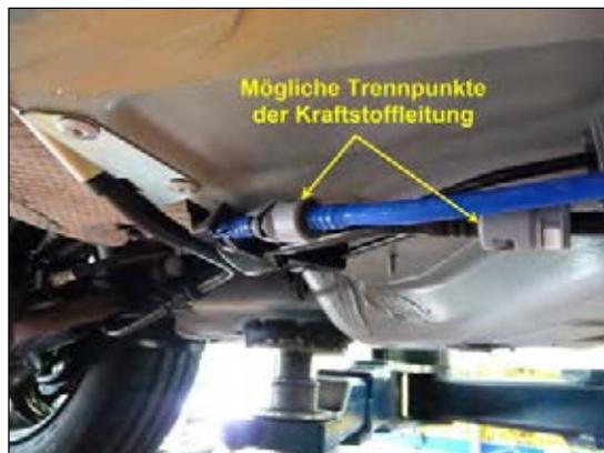
**Bild 10: Kraftstoffleitung demontieren**
