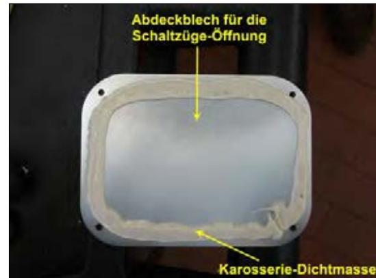
Bild 14: Abdeckung &amp; Karosserie-Dichtmasse
