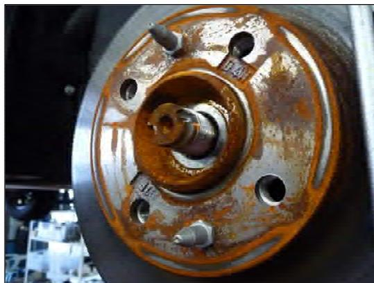
**Bild 5: Achsmutter lösen**
