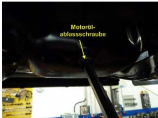
Bild 1: Motoröl ablassen
