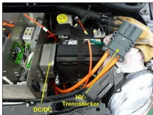
Bild 5: HV-Trennstecker anschließen
