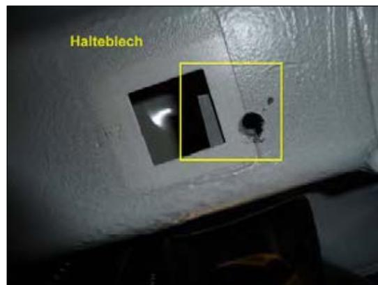
Bild 6: Halteblech mit einer Mutter M8
