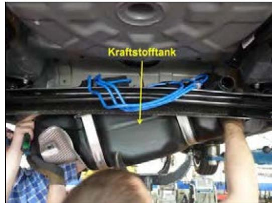
Bild 20: Kraftstofftank absenken
