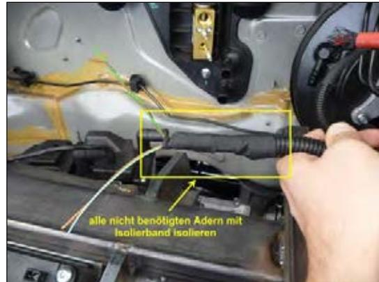
**Bild 6:** zusammenbinden mit Isolierband
