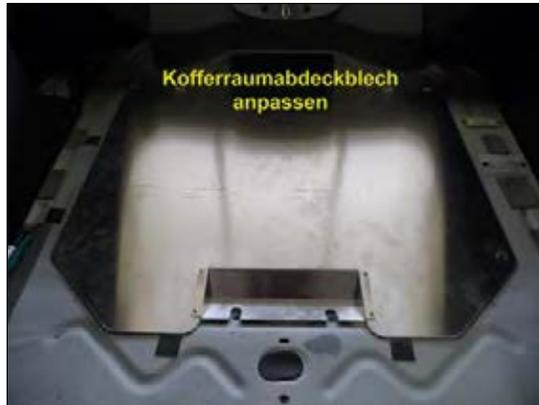
Bild 1: Kofferraumabdeckblech anpassen
