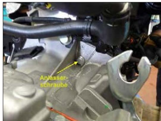
Bild 2: Anlasser demontieren
