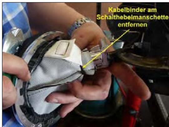
Bild 11: Schalthebelmanschette demontieren
