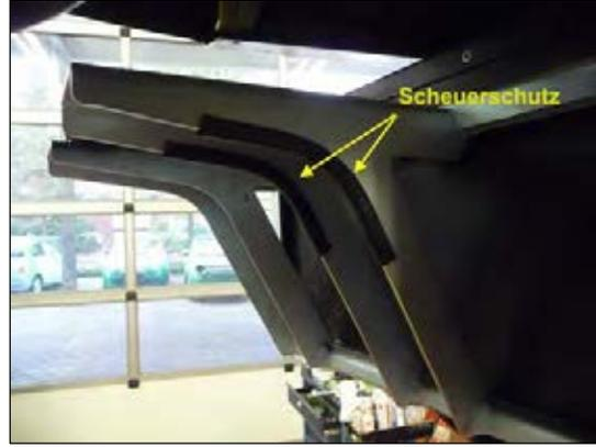
Bild 16: Scheuerschutz
