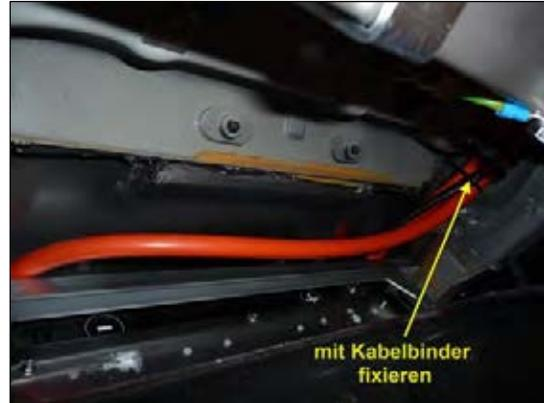
Bild 20: Kabel mit Kabelbinder fixieren
