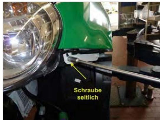
Bild 12: Scheinwerfer demontieren
