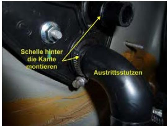
Bild 13: Stutzen des Heizwasserkreislaufs
