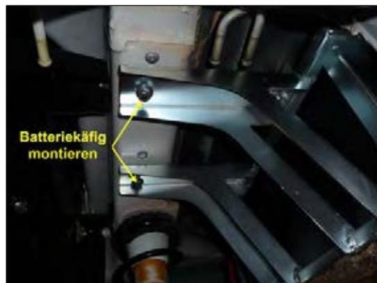
Bild 18: Batteriekäfig montieren
