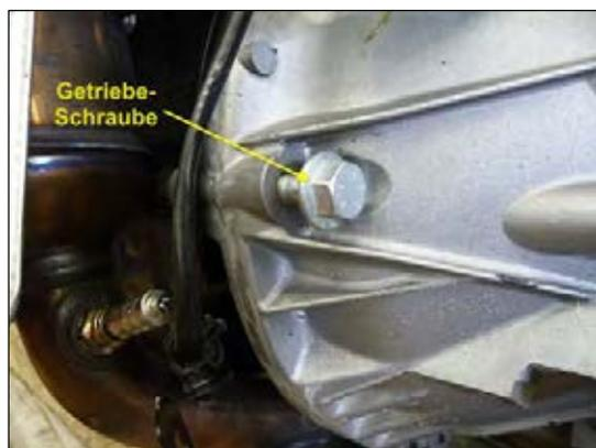
**Bild 3: Getriebe demontieren**
