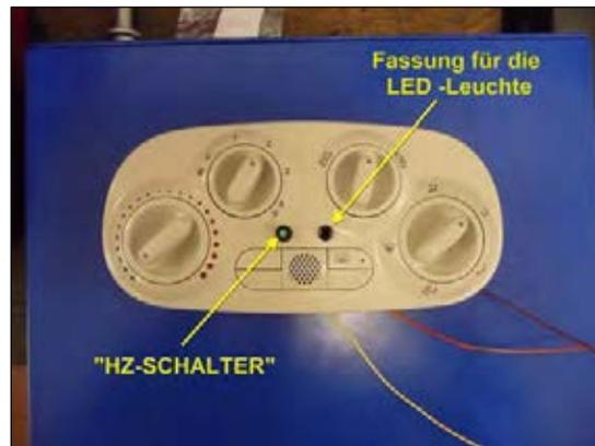
Bild 6: „HZ-SCHALTER“ & LED-Leuchte
