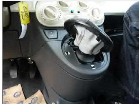
Bild 16: Verkleidung & Manschette montieren
