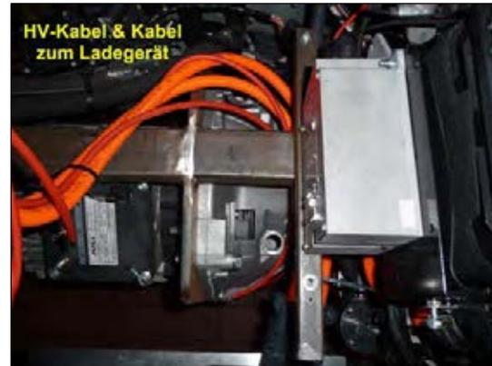
Bild 2: Kabel unter dem Motorträger verlegen
