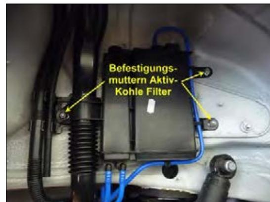
**Bild 4: Aktiv-Kohle-Filter demontieren**
