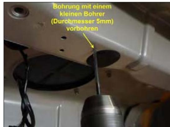
Bild 8: Bohrstelle vorbohren
