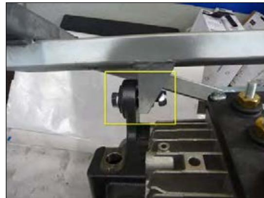
Bild 6: E-Motor an Motorträgerwinkel montieren
