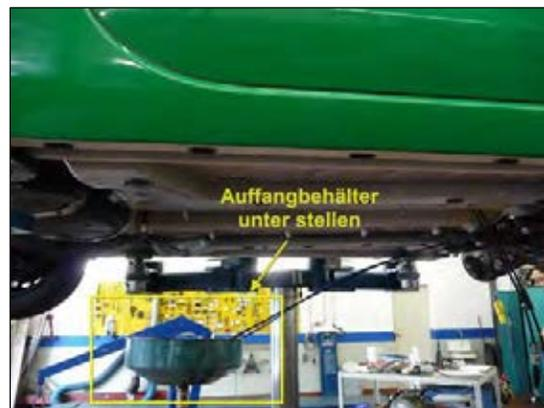
**Bild 12: Kraftstoffleitung demontieren**
