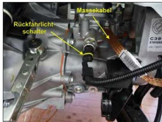
Bild 2: Massekabel & Rückfahrlichtschalter
