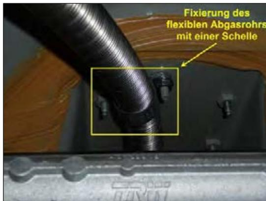
Bild 3: Fixierung des Abgasrohrs am Unterboden
