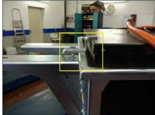
Bild 14: Niederhalter montieren
