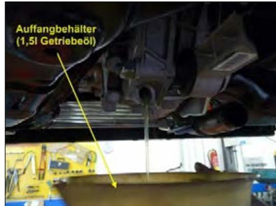
Bild 4: Getriebeöl ablassen &amp; auffangen
