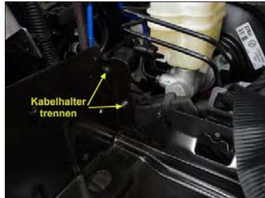
**Bild 4: Batteriekasten demontieren**
