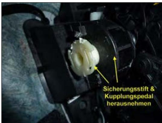
Bild 3: Sicherungstift & Kupplungspedal
