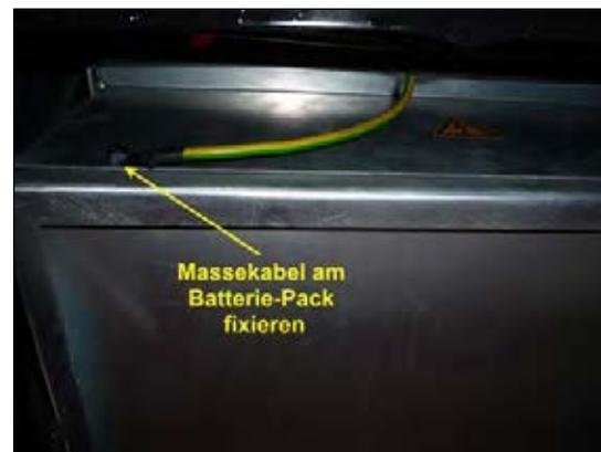
Bild 26: Massekabel am Spritzschutz fixieren
