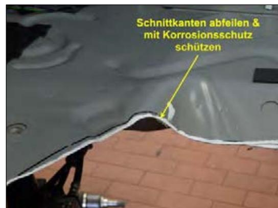
Bild 14: Schnittkanten entgraten &amp; schützen
