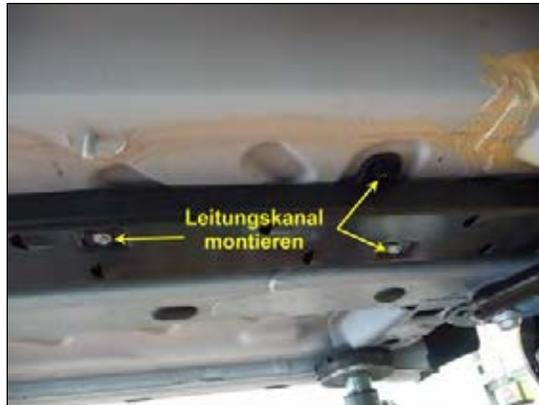
Bild 11: Leitungskanal montieren
