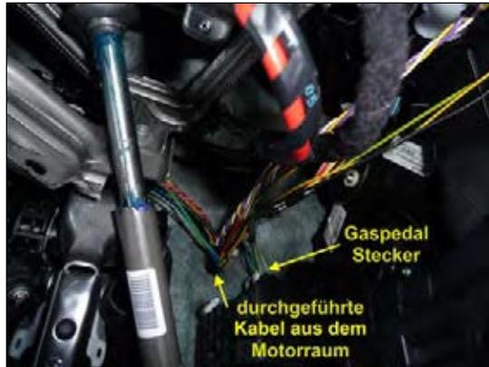
Bild 1: Gaspedal-Buchse
