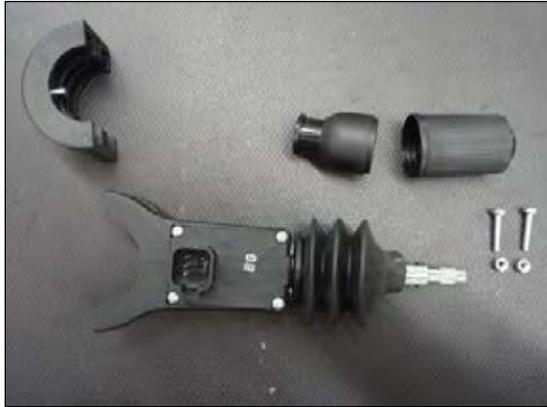
**Bild 3:** zerlegter Fahrstufenwahlhebel
