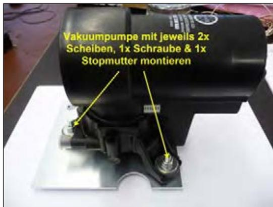
**Bild 3: Vakuumpumpe montieren**
