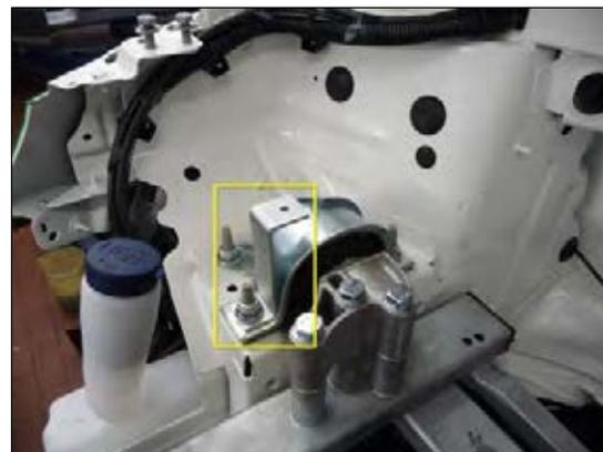
Bild 2: Montagewinkel Beifahrerseite
