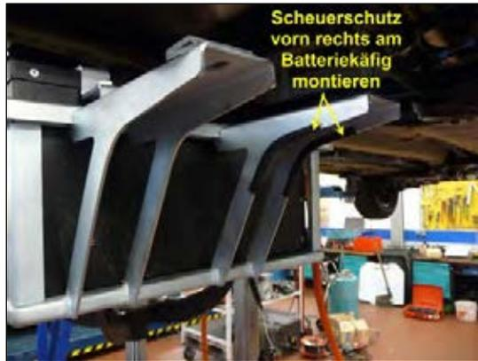
Bild 15: Scheuerschutz
