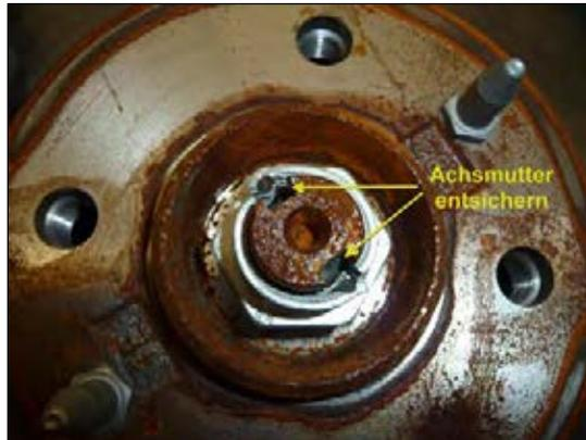
**Bild 3: Achsmutter entsichern**
