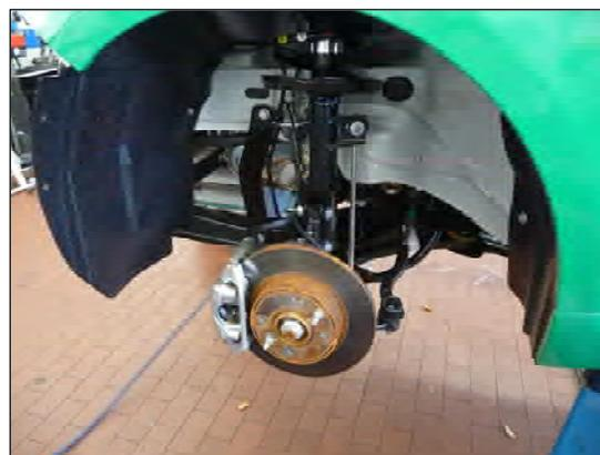
Bild 2: Demontage Achsmutter
