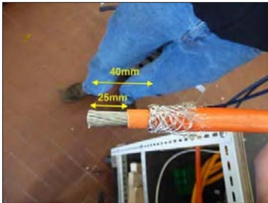
**Bild 15: HV-Kabel abisolieren**
