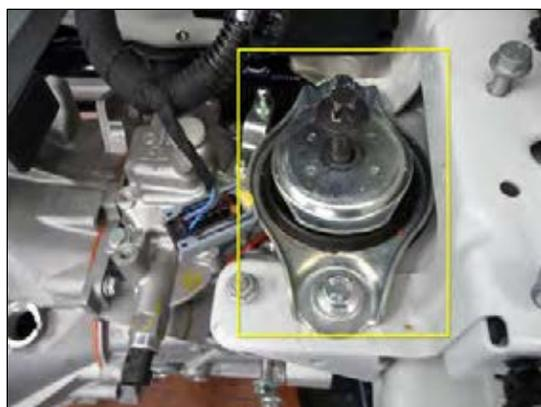
Bild 3: Motorhalter Fahrerseite
