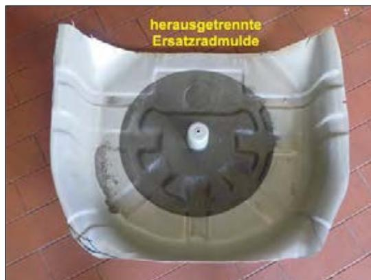
Bild 13: entfernte Ersatzradmulde
