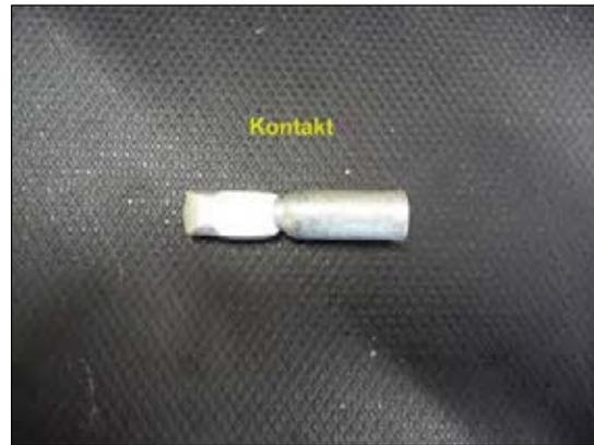
**Bild 16: Kontakt für HV-Kabel**
