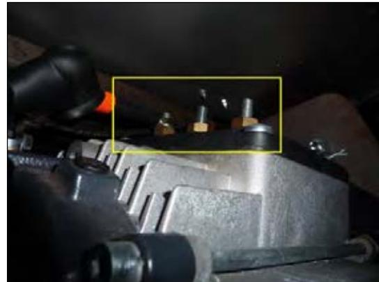
Bild 14: HV-Kabel „W“, „V“ & „U“ anschließen
