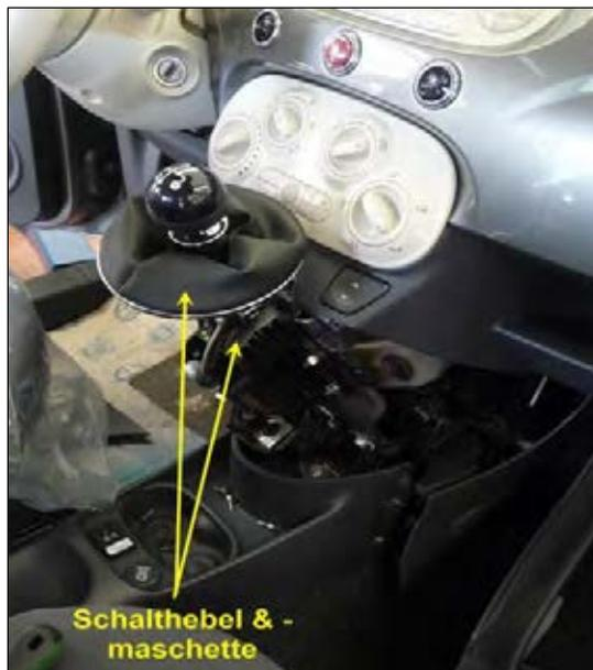
**Bild 5: Mittelkonsolenverkleidung demontieren**
