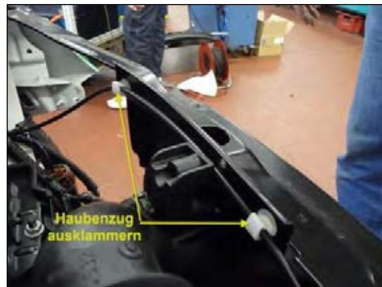
Bild 28: Haubenzug ausklammern
