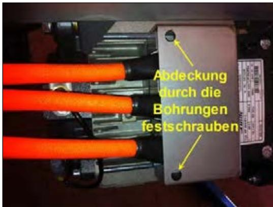
Bild 21: Abdeckung für Motoranschlüsse fixieren
