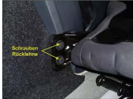
**Bild 4: Rücklehne demontieren**
