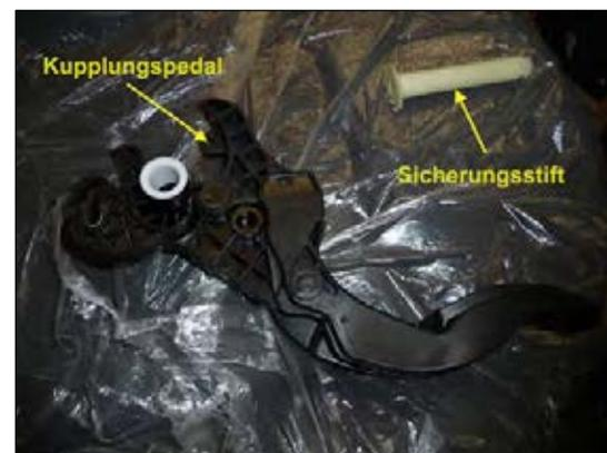
Bild 4: Sicherungstift & Kupplungspedal
