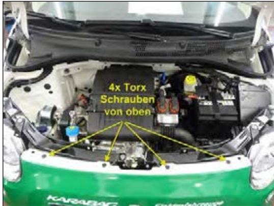
**Bild 1: Demontage der Stoßstange**
