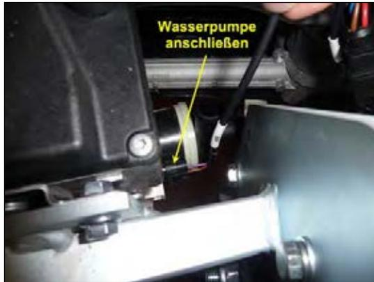
Bild 3: Wasserpumpe anschließen
