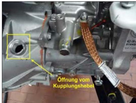
Bild 13: Öffnung vom Kupplungshebel
