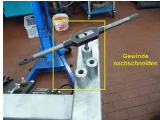
Bild 2: alle drei Gewinde nachschneiden M10x1,5
