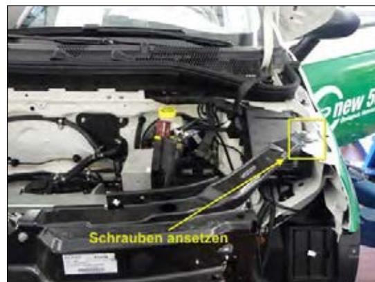
Bild 2: Fronttraverse ansetzen
