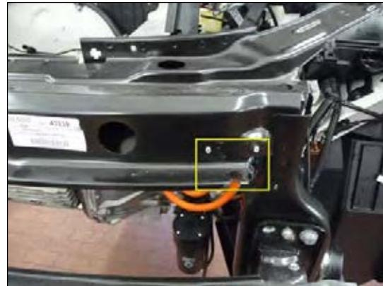
**Bild 4: Kühlerhalterung demontiert**
