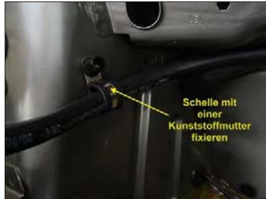
Bild 20: Schelle für Ø10mm Schlauch
