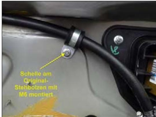
Bild 19: Schelle für Ø10mm Schlauch
