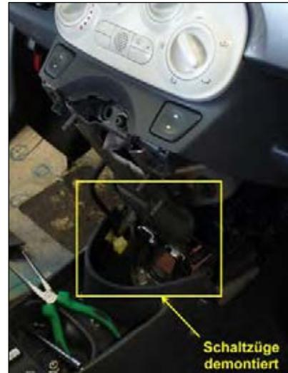
Bild 8: Schaltzüge demontieren
