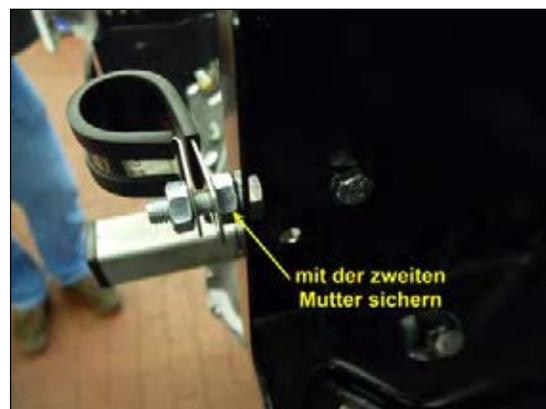
**Bild 6: Halteschelle montieren**
