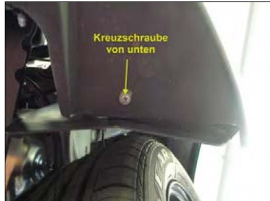
Bild 8: Demontage der Stoßstange
