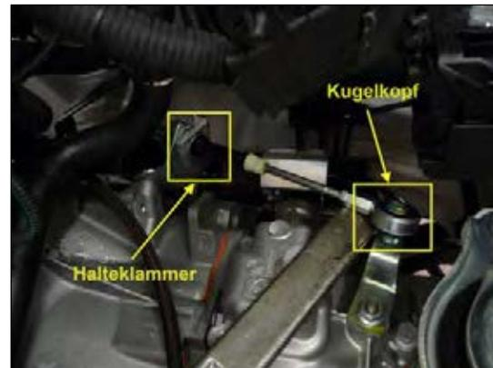
**Bild 8: Schaltseilzüge demontieren**
