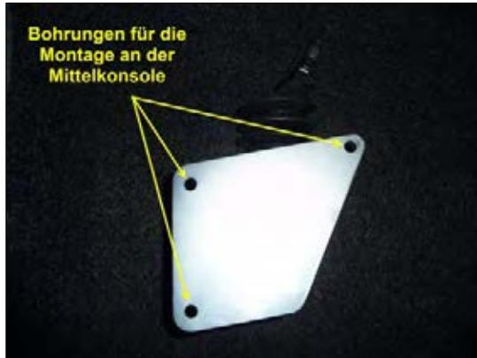
Bild 9: Montagebohrungen der Halter
