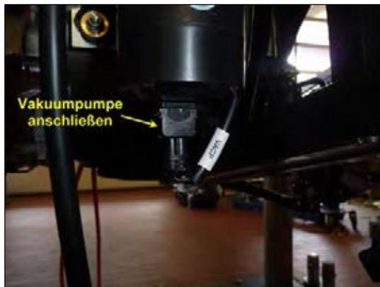
Bild 5: Vakuumpumpe anschließen
