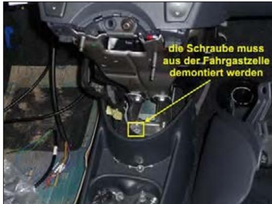
Bild 7: Austausch der original Schraube
