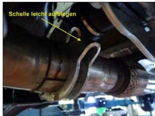
**Bild 4: Auspuffschellen lösen**
