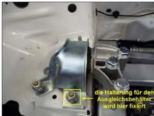
Bild 1: Motorhalter Beifahrerseite
