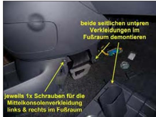
**Bild 2: untere Verkleidung lösen**
