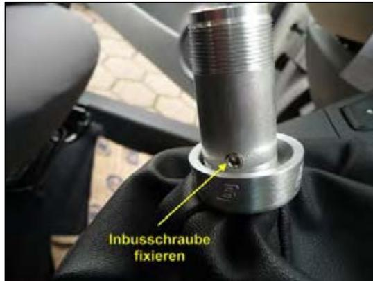
Bild 21: Gewindebuchse &amp; Scheibe montieren
