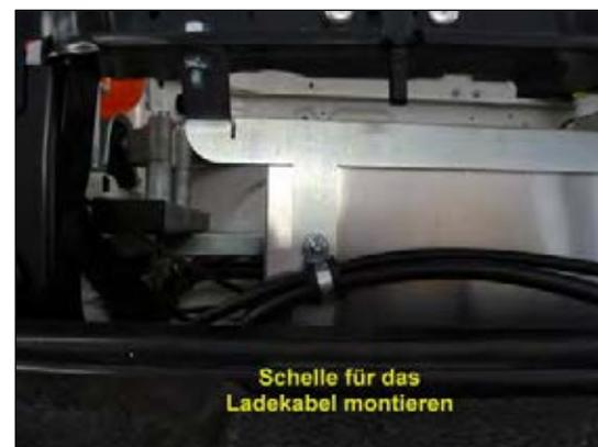
Bild 20: Schelle für das Ladekabel montieren
