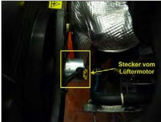
Bild 25: Stecker vom Lüftermotor trennen
