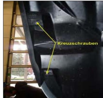
**Bild 2: Radkasten demontieren**
