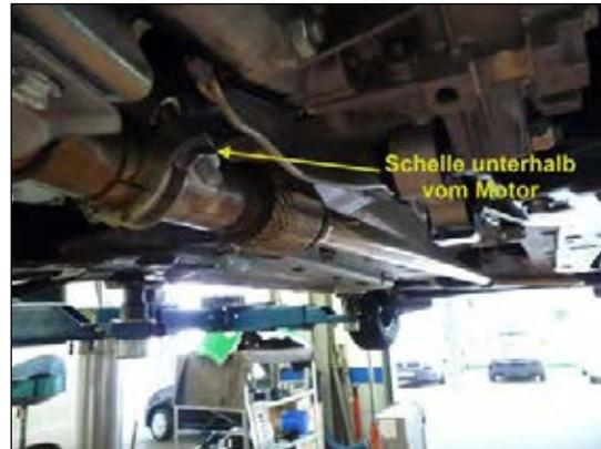
**Bild 2: Auspuffschellen lösen**
