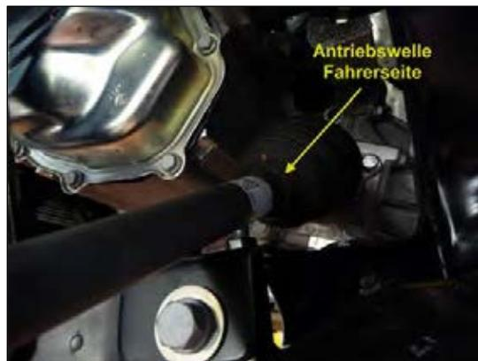
**Bild 11: Antriebswelle lösen**
