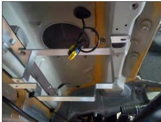
Bild 13: Kabel von der Kraftstoffpumpe fixieren
