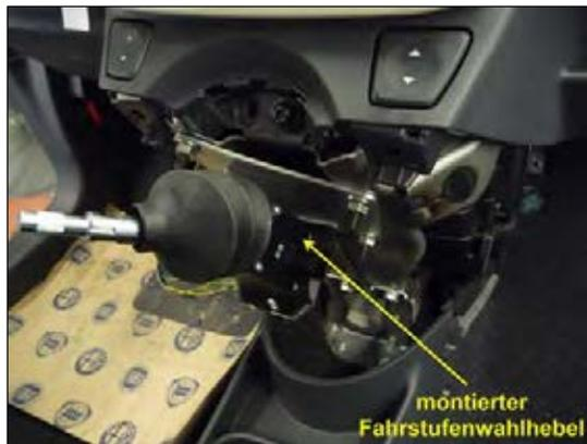
Bild 11: montierter Fahrstufenwahlhebel
