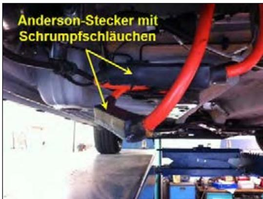
Bild 3: mit Schrumpfschläuchen isolieren
