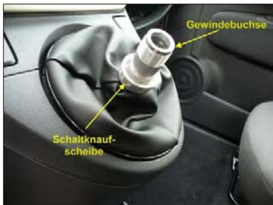
Bild 19: Gewindebuchse & Scheibe montieren
