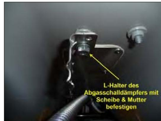
Bild 10: 90°-Halter montieren
