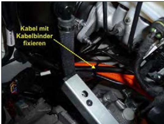
Bild 7: Kabel mit Kabelbinder fixieren
