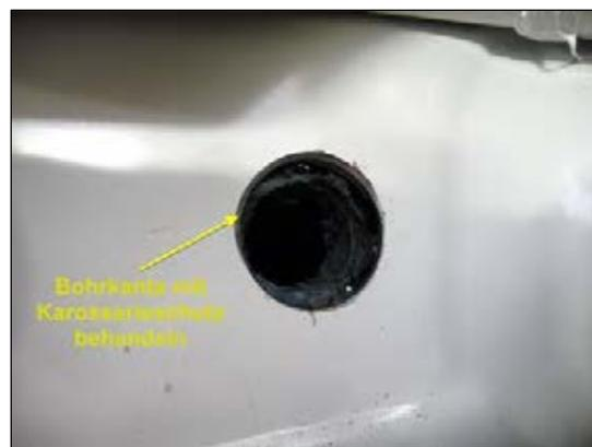
Bild 8: Bohrkante versiegeln
