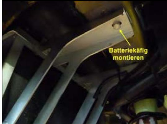
Bild 19: Batteriekäfig montieren
