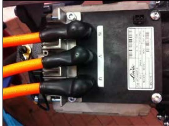
Bild 20: Schutzkappen montieren
