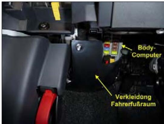
Bild 1: Verkleidung demontieren
