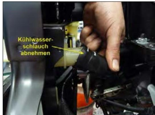
Bild 24: obere Kühlwasserschlauch abziehen
