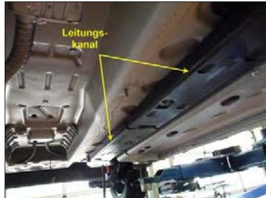
Bild 12: Kabelkanal montieren
