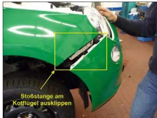
Bild 10: Demontage der Stoßstange
