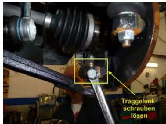
**Bild 6: Traggelenk lösen**
