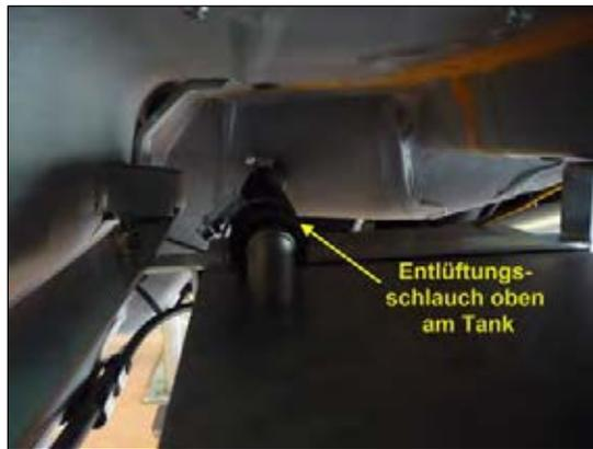
**Bild 13: Entlüftungsschlauch montieren**
