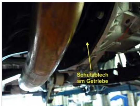
Bild 3: Schutzblech demontieren
