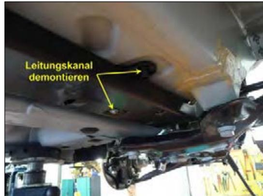
**Bild 8: Leitungskanal demontieren**
