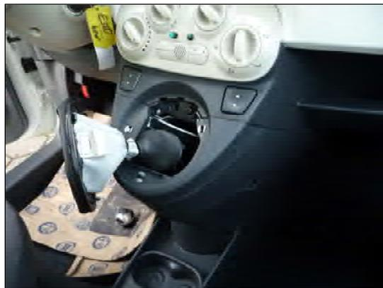
Bild 17: Verkleidung & Manschette montieren
