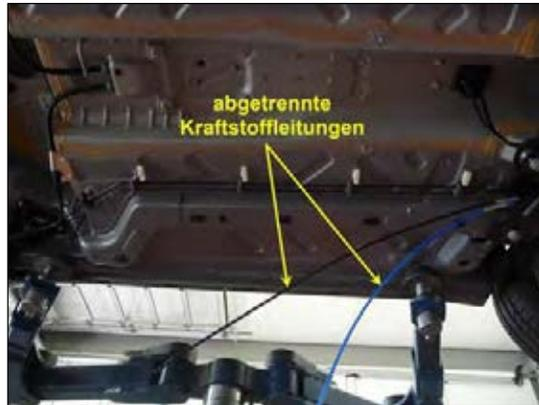
Bild 13: Kraftstoffleitung demontieren
