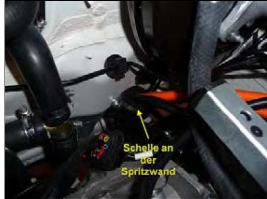
Bild 6: mit der Schelle fixieren
