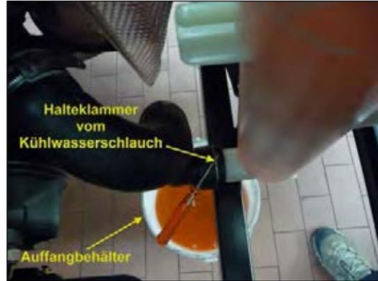
Bild 20: Halteklammer lösen
