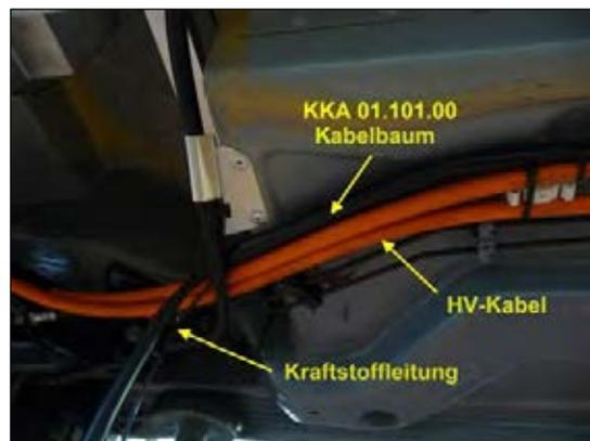
Bild 10: Kabel fixieren
