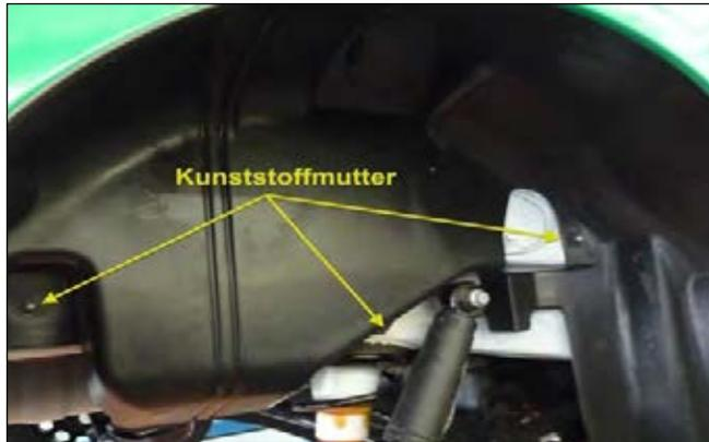
**Bild 1: Radkasten demontieren**
