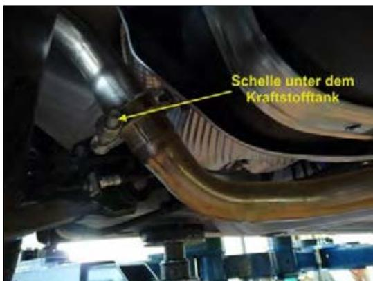
**Bild 5: Auspuffschellen lösen**
