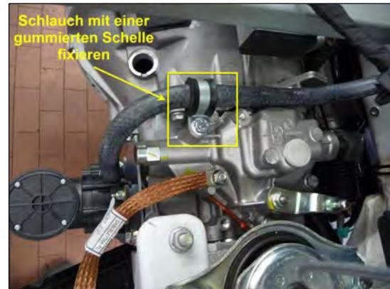
**Bild 10: Fixierung des Schlauchs**
