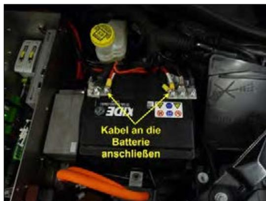
Bild 9: Kabel an die Batterie anschließen
