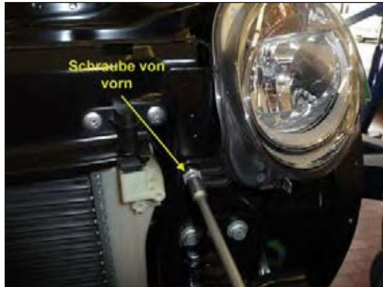
Bild 13: Scheinwerfer demontieren
