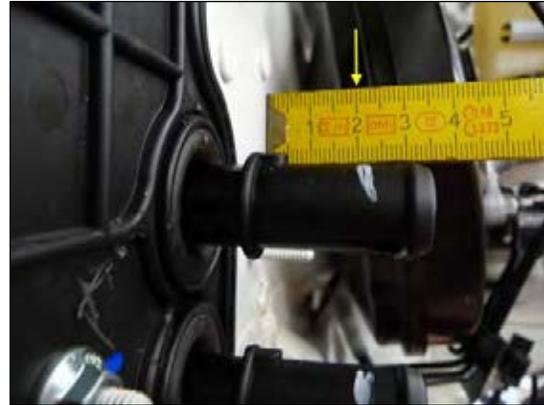
**Bild 10: Wasserstutzen kürzen**
