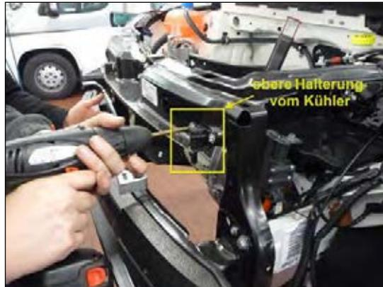
**Bild 3: Kühlerhalterung herausbohren**
