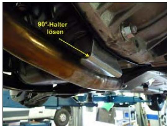
**Bild 9: 90°-Halter demontieren**
