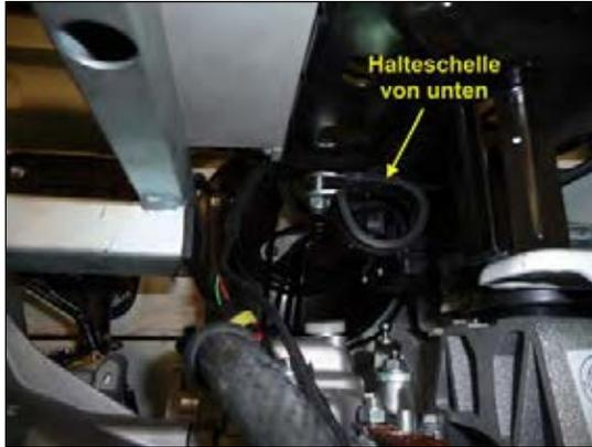
Bild 7: Halteschelle unter dem Batteriekasten
