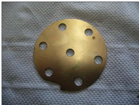
Bild 5: Sicherungsring Motorflansch
