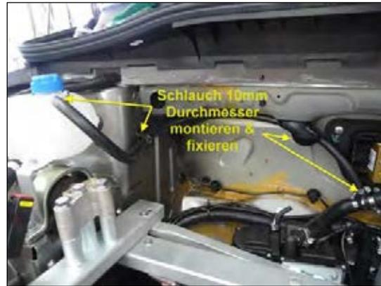
Bild 18: langer Schlauch Ø10mm
