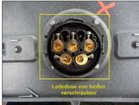
**Bild 11: Ladedose montieren**
