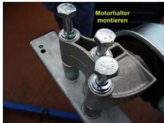
Bild 4: Motorhalter montieren
