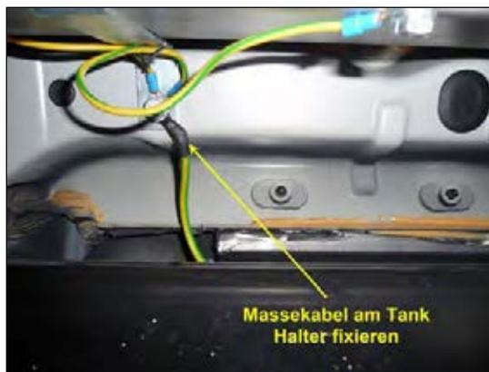
Bild 27: Massekabel am Tank-Halter fixieren
