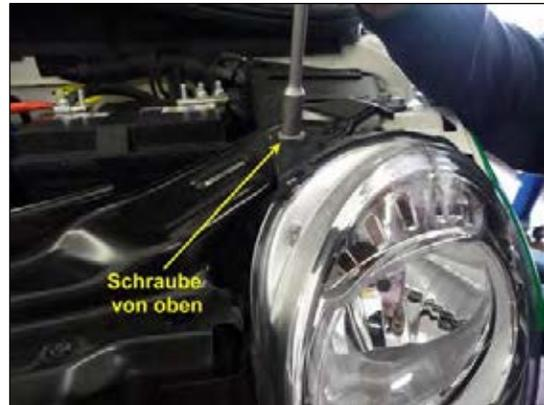
Bild 14: Scheinwerfer demontieren
