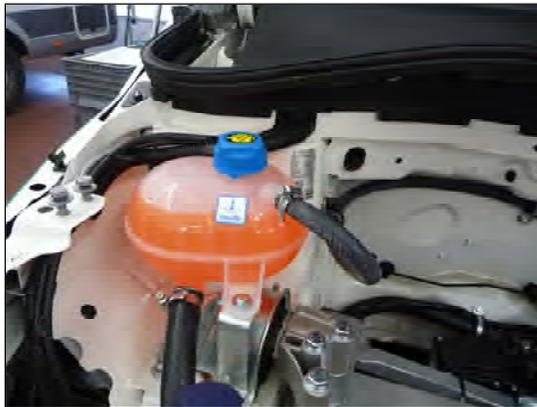
Bild 21: Wasserkreislauf befüllen &amp; entlüften
