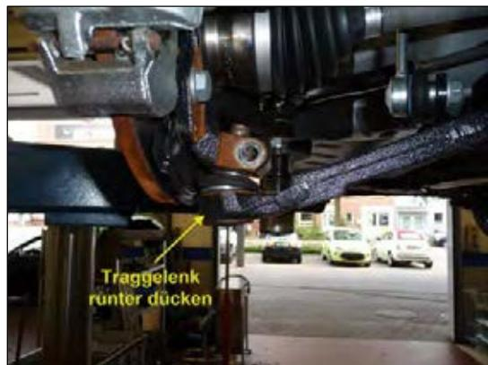
**Bild 8: Traggelenk lösen**
