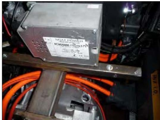
Bild 3: Kabel unter dem Motorträger verlegen
