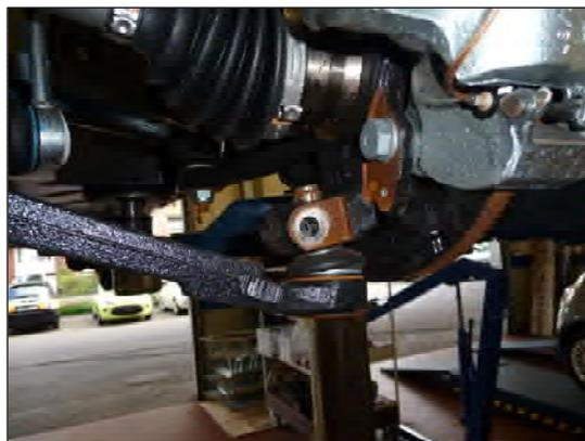
**Bild 7: Traggelenk lösen**
