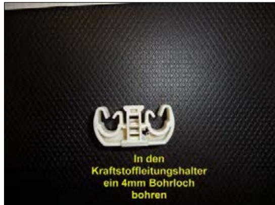
Bild 8: Kraftstoffleitungshalter
