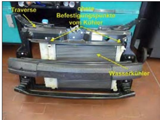
**Bild 31: Fronttraverse & Kühler**
