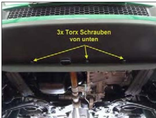
**Bild 3: Demontage der Stoßstange**
