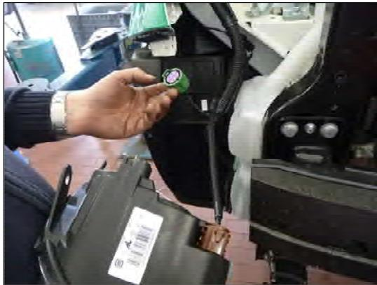
Bild 1: Stecker montieren
