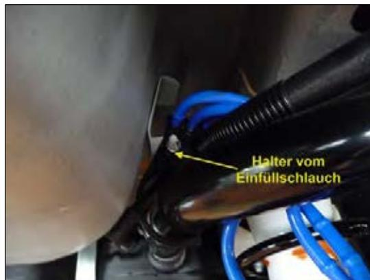
Bild 15: Schlauchhalter demontieren
