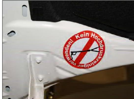
Bild 8: Warnhinweis unter der Motorhaube
