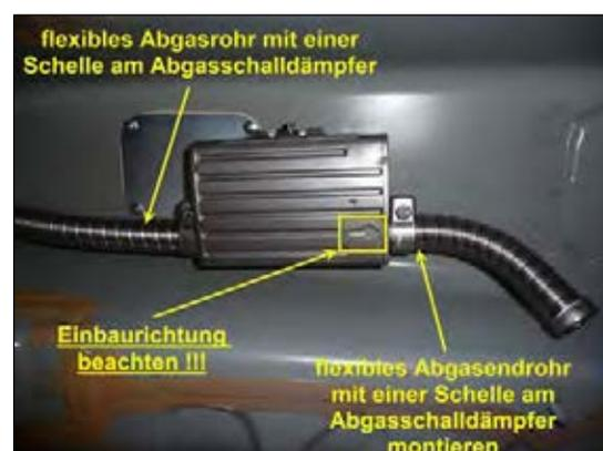
Bild 12: Montage Abgasrohr & Abgasrohr
