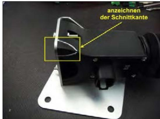
**Bild 6:** Schnittkante anzeichnen
