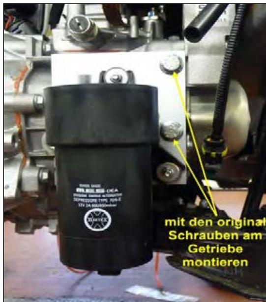
**Bild 5: am Getriebe montieren**
