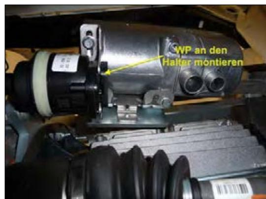
Bild 6: Wasserpumpe montieren
