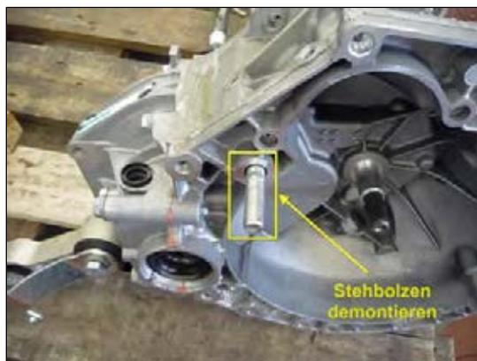
**Bild 7:** Stehbolzen demontieren
