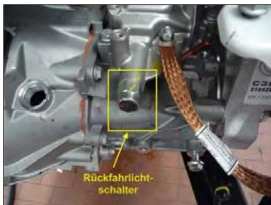
**Bild 9:** Rückfahrlichtschalter abgetrennt
