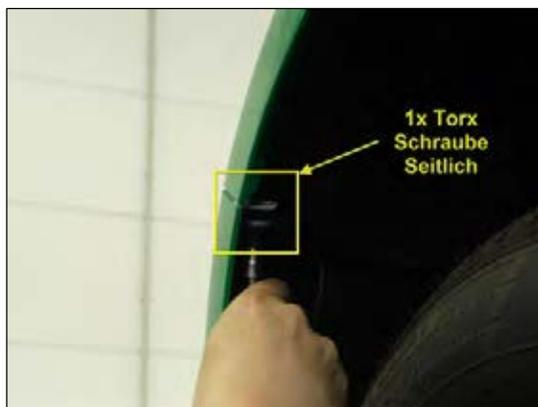
**Bild 5: Demontage der Stoßstange**
