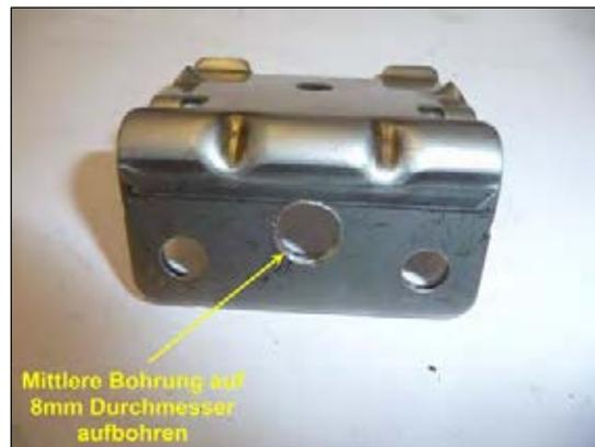
Bild 4: 90°-Halter für die Standheizung
