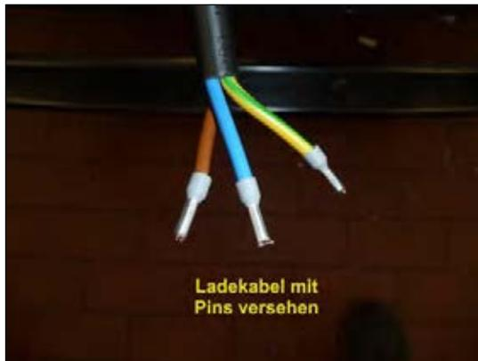
Bild 1: Ladekabel vom Ladegerät
