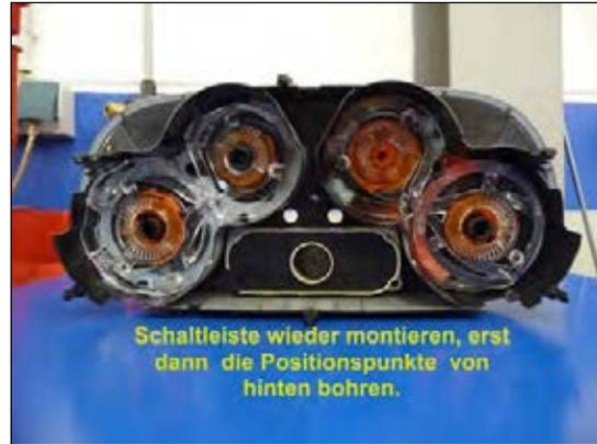
Bild 4: Bohrlöcher ermitteln & bohren
