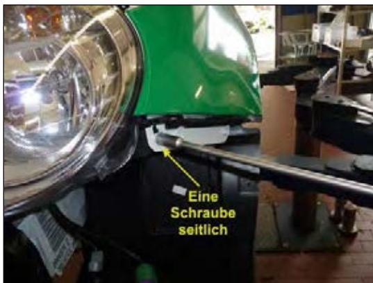
Bild 3: Schrauben montieren
