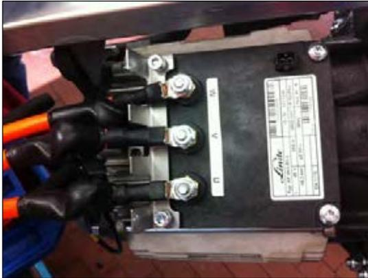
Bild 19: HV-Kabel anschließen
