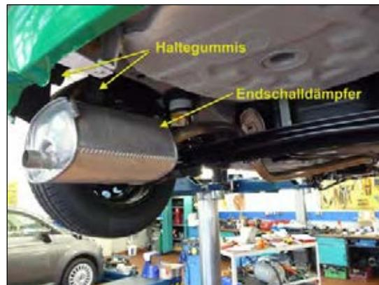
**Bild 6: Endschalldämpfer demontieren**
