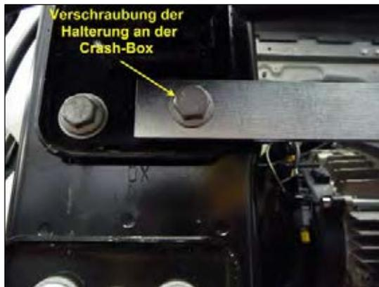
Bild 17: Ladegeräthalterung montieren
