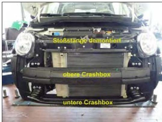
Bild 11: Stoßstange demontiert
