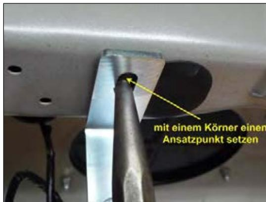
Bild 7: Bohrstelle kornen
