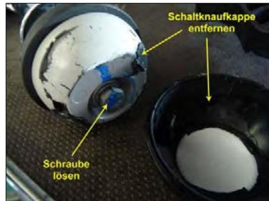
Bild 10: Schalthebelmanschette demontieren
