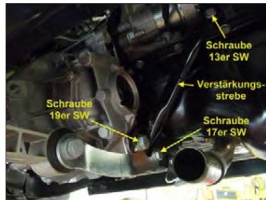
Bild 2: Haltestrebe demontieren
