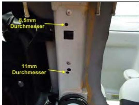
Bild 3: Bohrlöcher aufbohren
