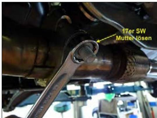
**Bild 3: Auspuffschellen lösen**
