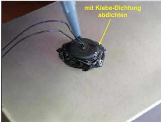
**Bild 5:** Tankgeber mit Klebe-Dichtung abdichten
