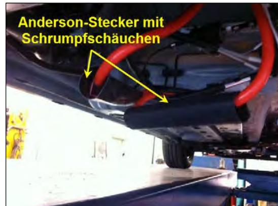
Bild 2: Schrumpfschläuche montieren
