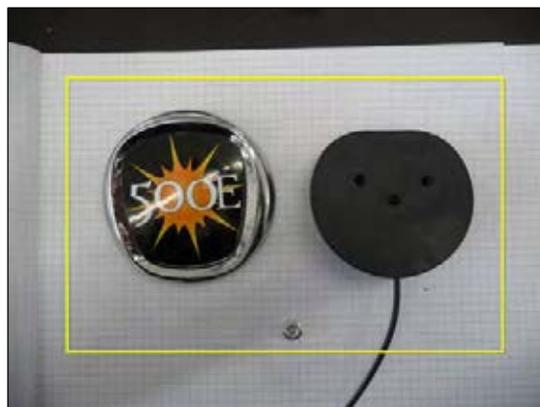
Bild 9: Deckel mit dem Emblem verschrauben
