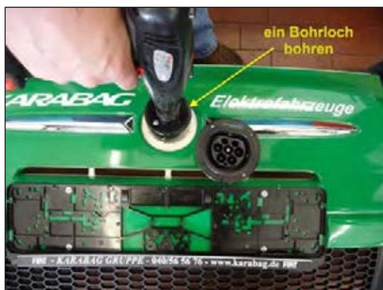
Bild 3: Stoßstange aufbohren
