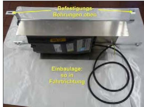
Bild 10: zusammenmontierte Ladegeräteinheit
