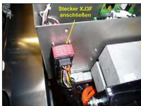
Bild 12: Stecker XJ3F an Multi-Box anschließen
