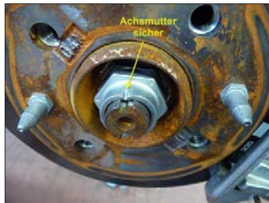
Bild 4: Achsmutter verschrauben & sichern
