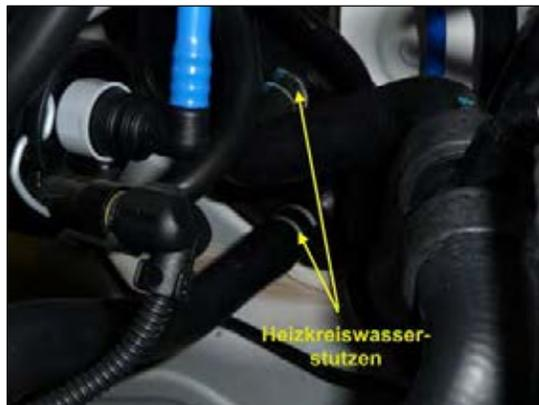
Bild 11: Wasserschläuche demontieren
