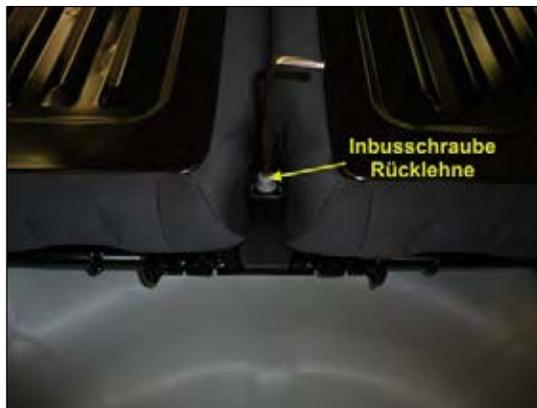
**Bild 5: Rücklehne demontieren**
