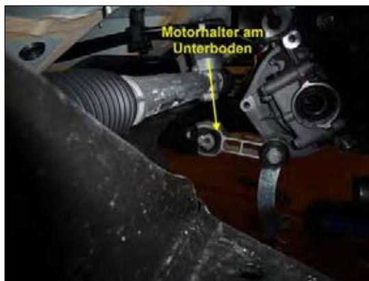
**Bild 1: untere Motorhalter demontieren**
