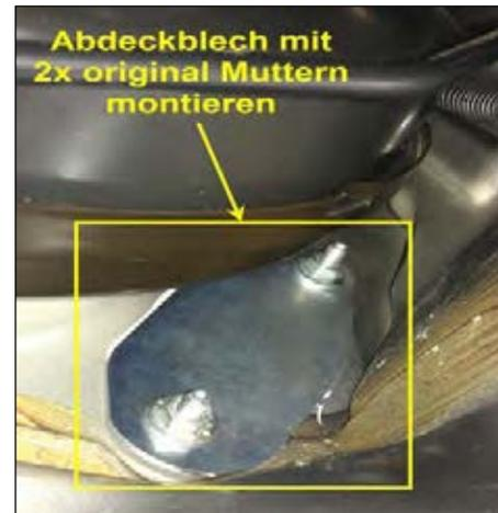
Bild 10: Abdeckung montieren
