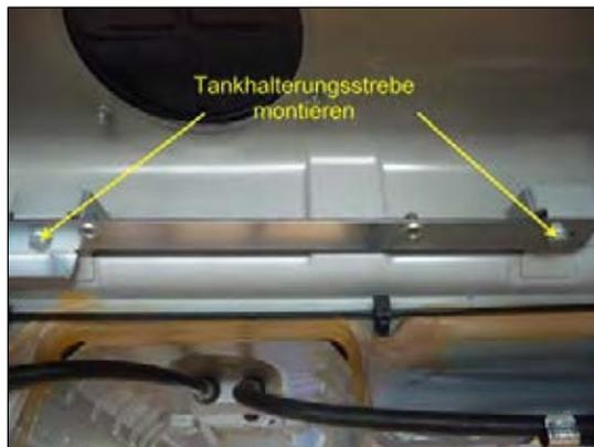
**Bild 3: Tankhalterstrebe montieren**
