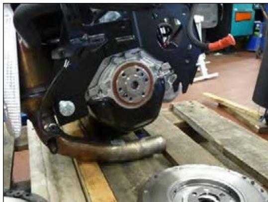
**Bild 3: demontierte Kupplungs- & Schwungscheibe**
