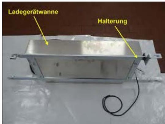
Bild 11: vormontierte Ladegeräteinheit
