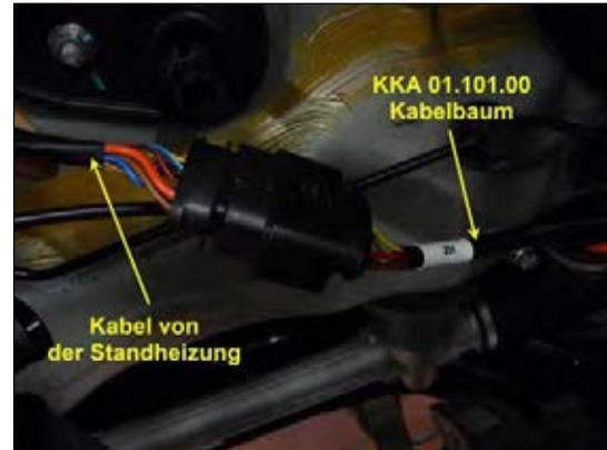
Bild 4: Standheizung anschließen
