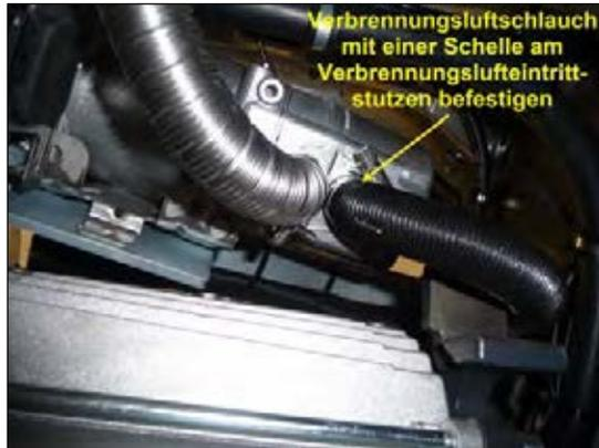
Bild 13: Montage Verbrennungsluftschlauch
