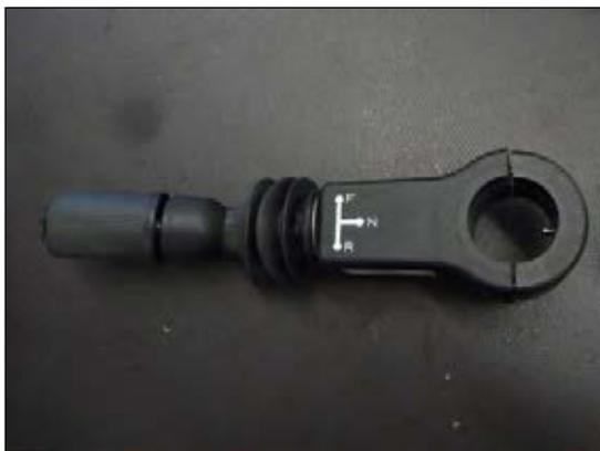
**Bild 1: Fahrstufenwahlhebel**
