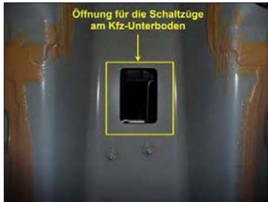
Bild 13: Schalthebelzug-Öffnung im Tunnel
