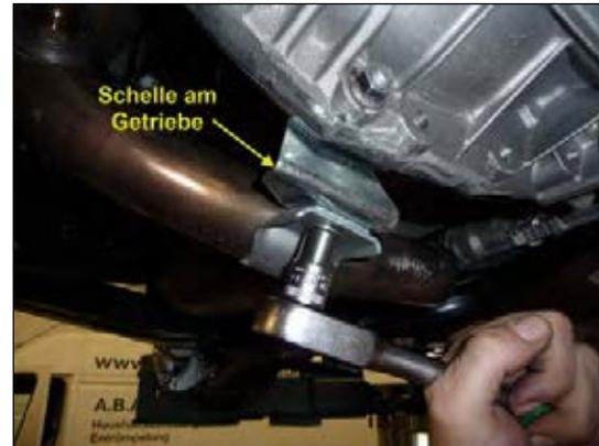
**Bild 8: Halteschelle demontieren**
