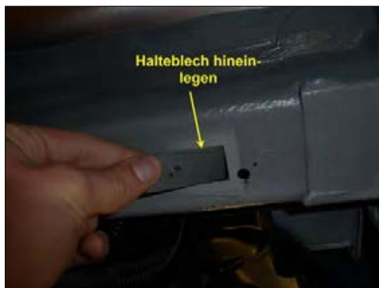
Bild 5: Halteblech mit einer Mutter M8
