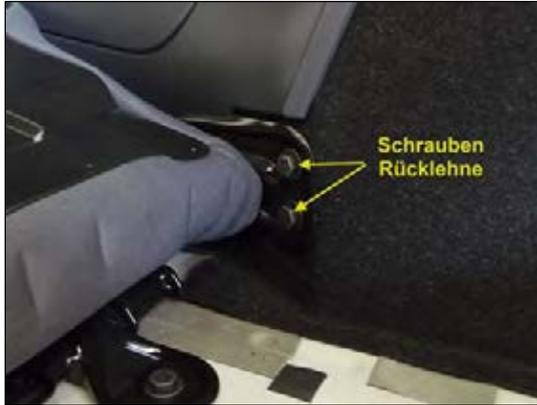
**Bild 3: Rücklehne demontieren**
