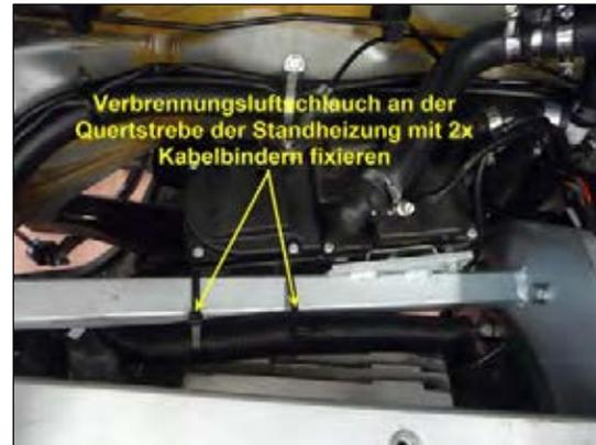
Bild 16: Verbrennungsluftschlauch fixieren
