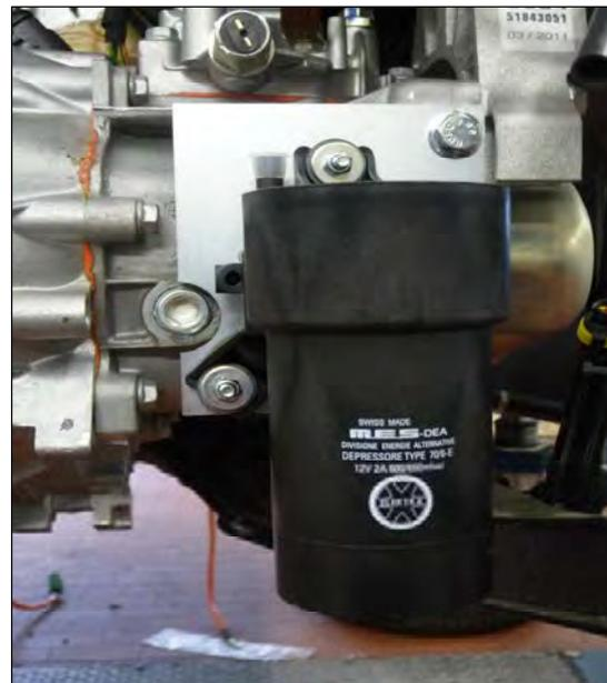
**Bild 6: Ausrichtung der Montageplatte beachten**
