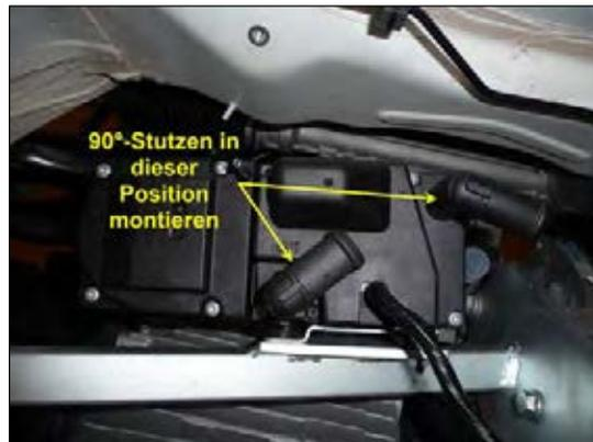
Bild 4: Wasserstutzen auswechseln
