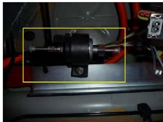
Bild 4: Dosierpumpe montieren
