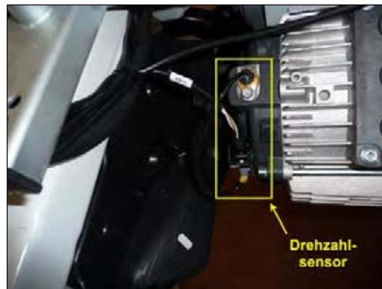
**Bild 4: Drehzahlsensor anschließen**
