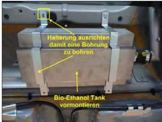
Bild 5: Tankhalter ausrichten
