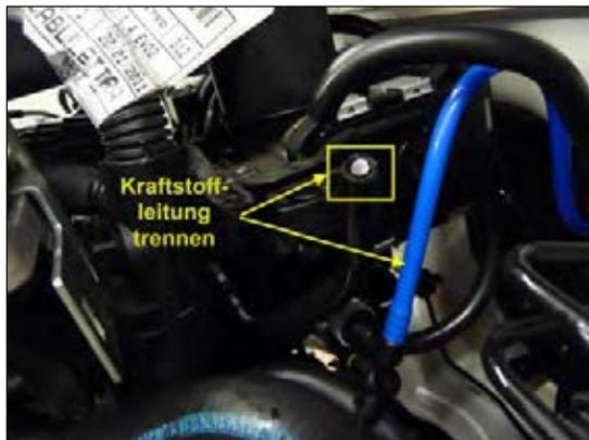
Bild 12: Kraftstoffleitungen demontieren
