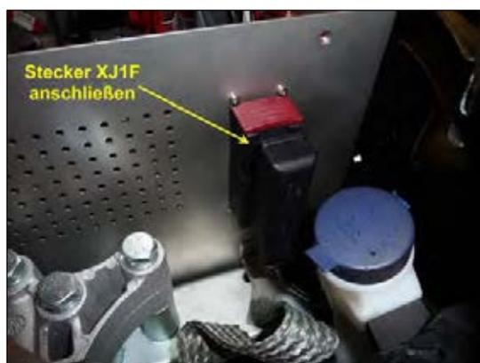
Bild 11: Stecker XJ1F an Multi-Box anschließen
