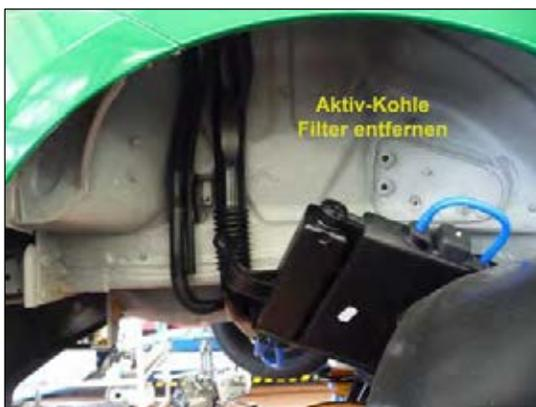
**Bild 5: Aktiv-Kohle-Filter demontieren**
