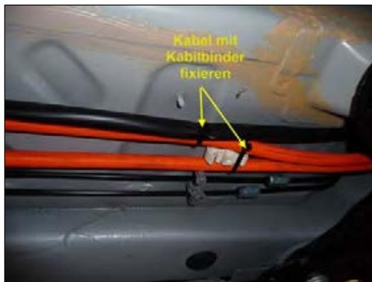
Bild 9: Kabel mit Kabelbindern fixieren
