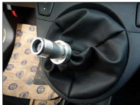
Bild 20: Gewindebuchse & Scheibe montieren
