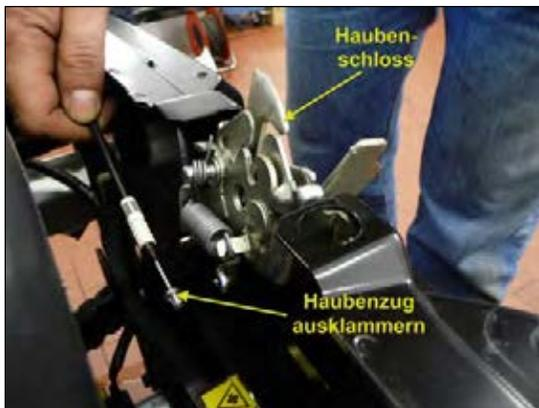
Bild 27: Haubenzug ausklammern
