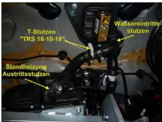
Bild 17: Standheizung & Heizwasserkreislauf
