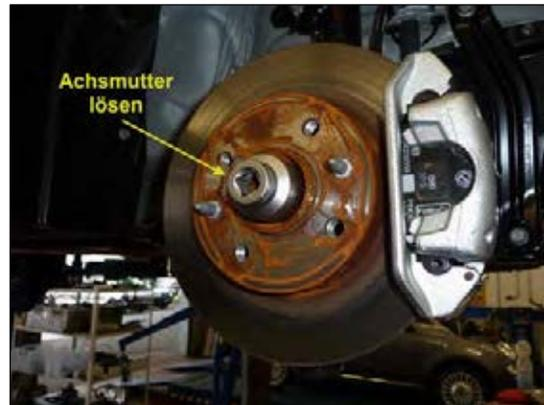
**Bild 4: Achsmutter lösen**
