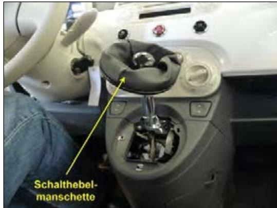
**Bild 1: Schalthebelmanschette hochziehen**
