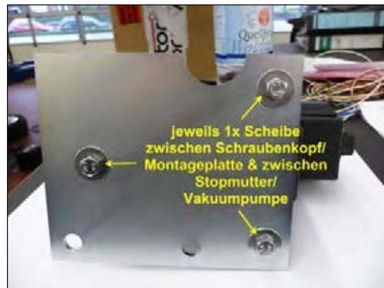
**Bild 4: Vakuumpumpe montieren**
