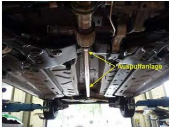
**Bild 1: Auspuffanlage**
