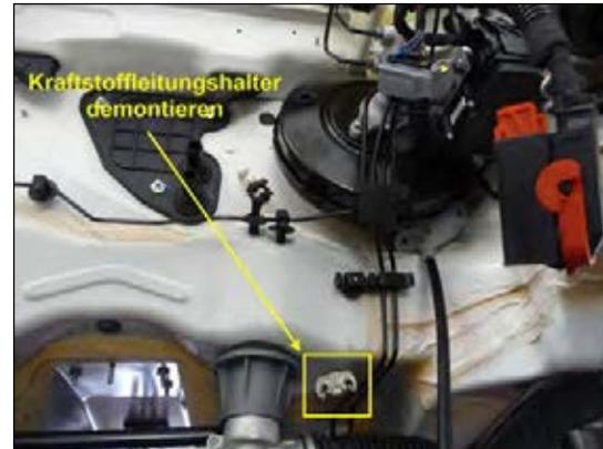
Bild 14: Kraftstoffleitungshalter demontieren
