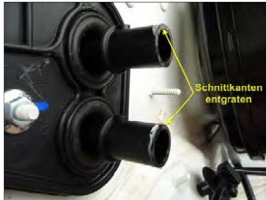
**Bild 11: Schnittkanten entgraten**
