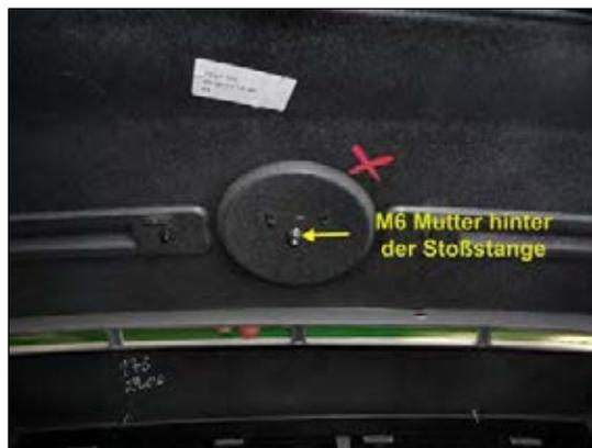
Bild 1: original Emblem demontieren
