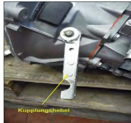
Bild 2: Kupplungshebel demontieren
