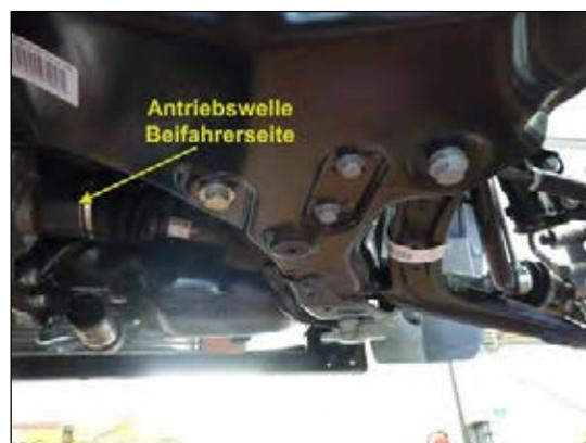
**Bild 12: Antriebswelle lösen**
