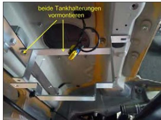
**Bild 4: Tankhalterstrebe montieren**
