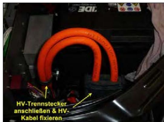
Bild 6: HV-Trennstecker anschließen
