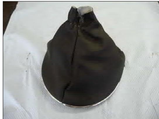
Bild 12: demontierter Schalthebelmanschette
