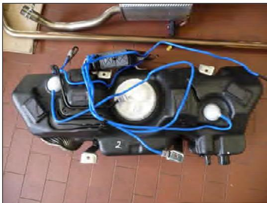
Bild 21: Kraftstofftank mit Aktiv-Kohle-Filter
