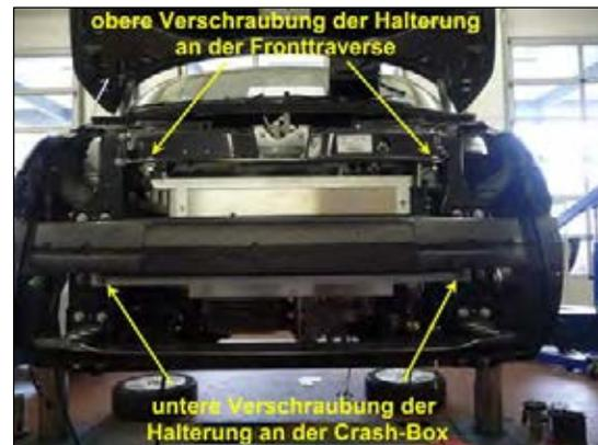
Bild 12: Befestigungspunkte der Ladegeräteinheit
