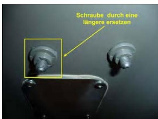
Bild 6: Austausch der original Schraube
