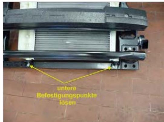
Bild 30: untere Befestigungsschrauben lösen
