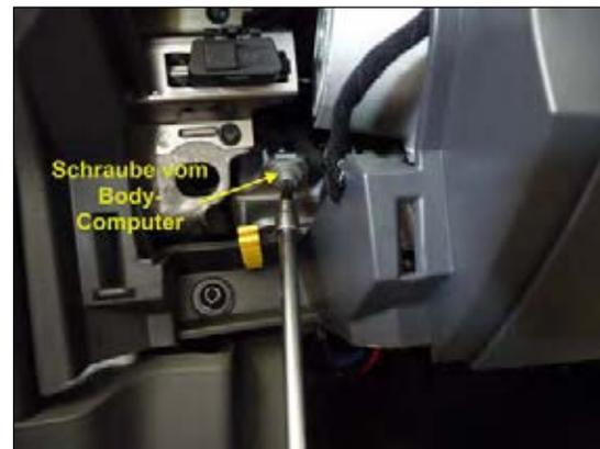
Bild 2: Body-Computer lösen
