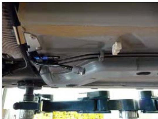
**Bild 11: Kraftstoffleitung demontieren**
