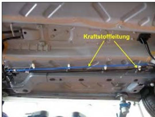
**Bild 9: Kraftstoffleitung demontieren**
