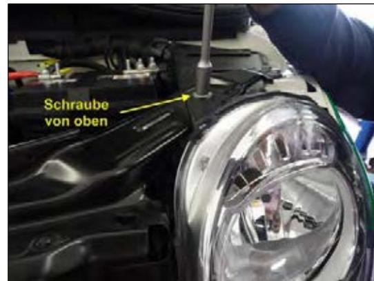
Bild 2: Schrauben montieren
