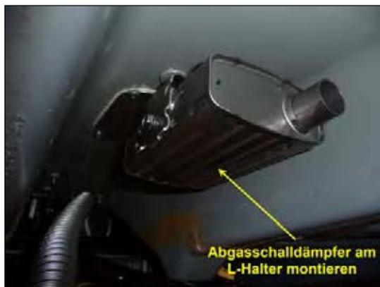
Bild 11: Abgasschalldämpfer montieren
