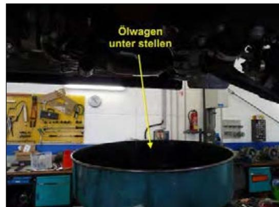
Bild 2: Motoröl ablassen
