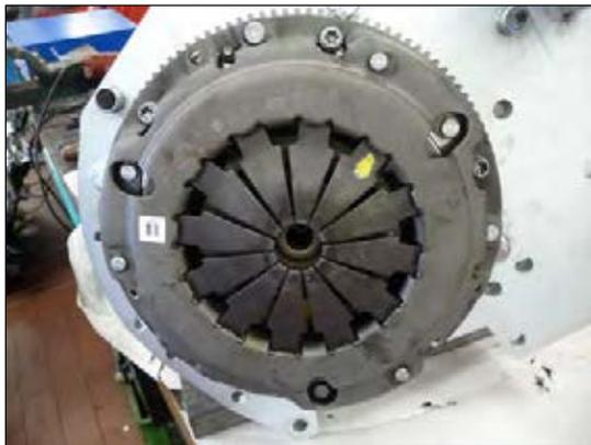
Bild 9: Kupplungsscheibe montiert
