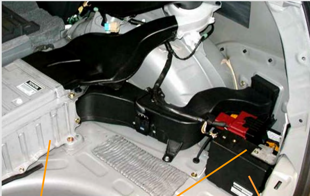
201,6V Hochleistungs- Batterie
