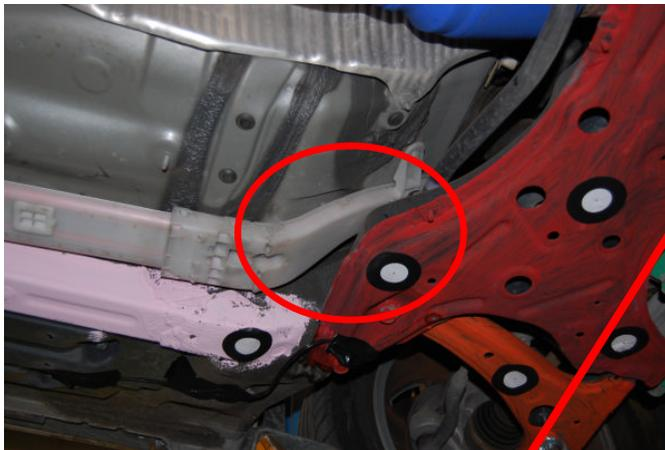
*Keine Verletzung der HV-Kabel am Unterboden*
