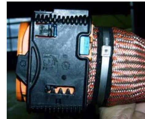
HV-Stecker mit 3-fach-Entriegelung
