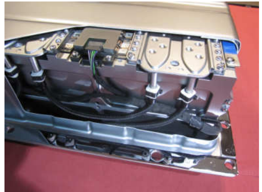
Batteriesystem mit Kühlvorrichtung
