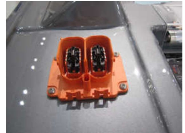
Orangene Kennzeichnung von Hochvoltbereichen
