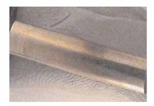
Pumpenkolben mit hoher Laufleistung aber normal, da richtiger Kraftstoff.
