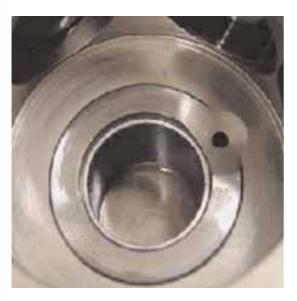
CP1 Pumpengehäuse leichter Verschleiß, in Ordnung
