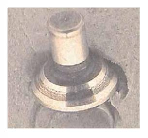
Saugventil mit hoher Laufleistung aber dicht und in Ordnung.
