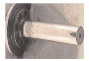
Pumpenkolben und Federteller normal, da richtiger Kraftstoff.
