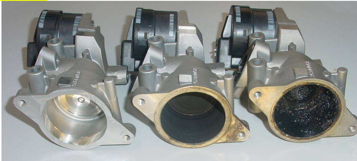
Bild 13 Eingeschränkte Arbeitsweise eines elektromotorisch angesteuerten AGR-Ventils. AGR-Ventil mit starken Ablagerungen (rechts), im Neuzustand (links) und bei normalem Einsatz (mitte).
