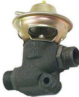
Bild 3 AGR-Ventil eines Mercedes 280 von 1985. Die Abgasrückführung ist eine erprobte und bewährte Methode zur Schadstoffreduzierung.
