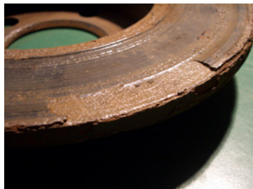
Abbildung 134: Abplatzen der Rostschicht
