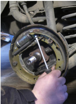
Abbildung 104: Lösen der oberen Feder
