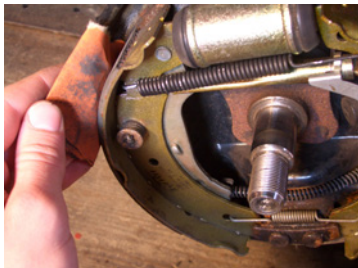
Abbildung 114: Abschleifen der Beläge
