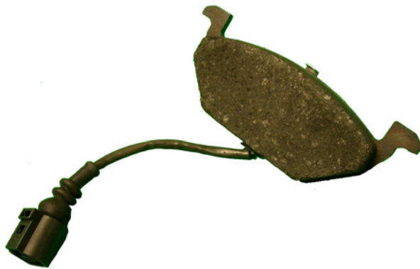
Abbildung 17: Bremsbelag mit Verschleißsensor
