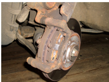
Abbildung 75: Hochklappen des Bremssattel 3
