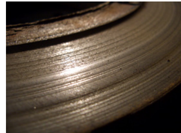
Abbildung 132: Riefen auf Bremsscheibe
