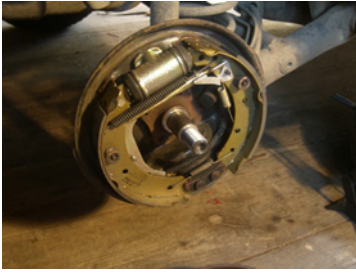
Abbildung 102: Trommelbremse mit abzogener Trommel
