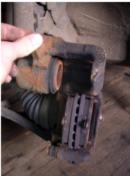
Abbildung 52: Hochklappen des Bremssattel 1
