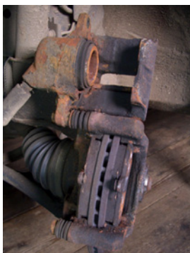
Abbildung 74: Hochklappen des Bremssattel 2
