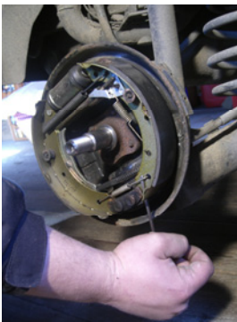
Abbildung 103: Lösen der unteren Feder
