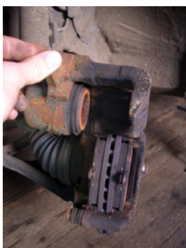
Abbildung 73: Hochklappen des Bremssattel 1
