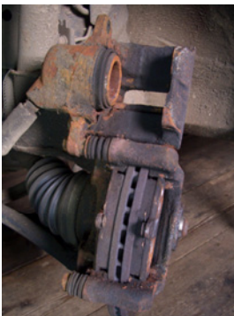
Abbildung 53: Hochklappen des Bremssattel 2
