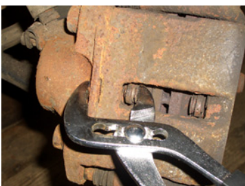
Abbildung 70: Zurückdrücken des Kolbens
