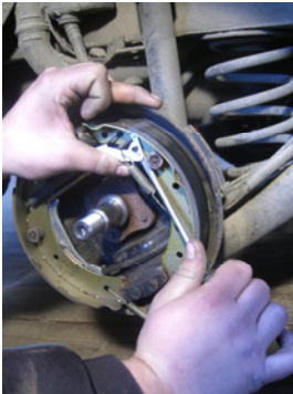
Abbildung 106: Lösen der Selbstnachstellung
