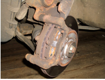
Abbildung 54: Hochklappen des Bremssattel 3
