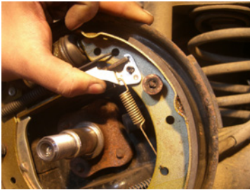
Abbildung 105: Spannfeder der selbsttätigen Nachstellvorrichtung
