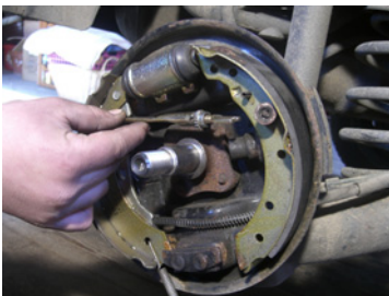
Abbildung 107: Entnahme der Selbstverstellung
