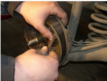
Abbildung 109: Lösen der Lagerung
