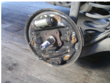
Abbildung 113: Punkte die mit Kupferpaste bestrichen werden
