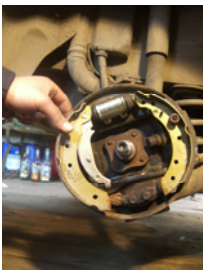
Abbildung 110: Herausnehmen der Bremsbeläge
