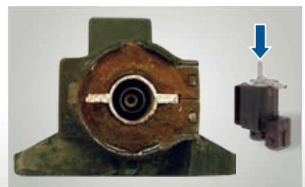
Korrodiertes Elektromschaltventil (geöffnet)
