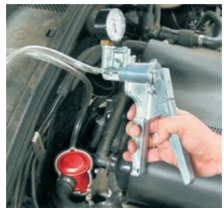
Prüfen eines Sekundärluftventils mit einer Unterdruckhandpumpe
