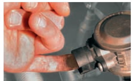
„Fingerprobe“ am Sekundärluftventil im BMW 520i (hervorgehoben) Sind auf dieser Seite Ablagerungen vorhanden, ist das Rückschlagventil undicht und muss erneuert werden.
