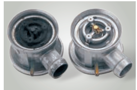
Geöffnetes Sekundärluftventil links: Schäden durch Abgaskondensat rechts: Neuzustand
