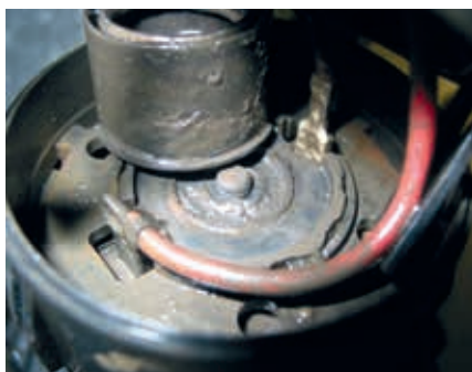
Aggressives Abgaskondensat im Antriebsmotor einer Sekundärluftpumpe
