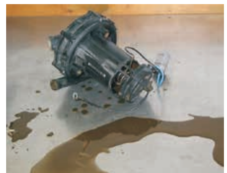
Flüssiges Abgaskondensat aus einer Sekundärluftpumpe
