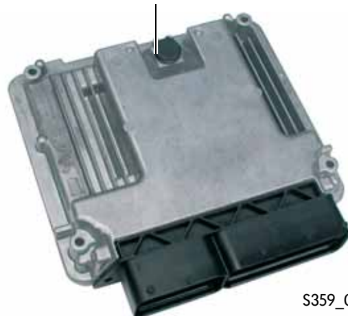
Motorsteuergerät mit dem Geber für Umgebungsdruck
