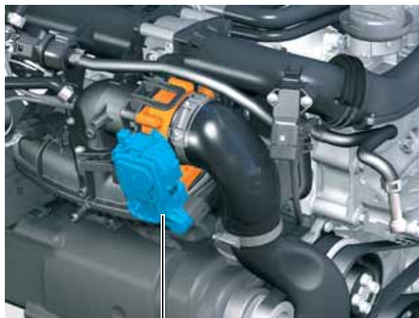
Drosselklappen-Steuereinheit J338 mit Drosselklappenantrieb G186
