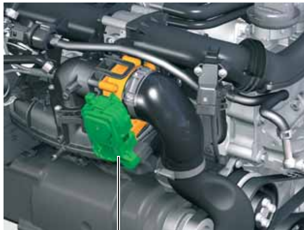
Drosselklappen-Steuereinheit J338 mit Winkelgeber für Drosselklappenantrieb G187 und G188 S359_050
