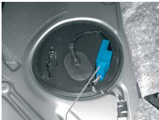
Steuergerät für Kraftstoffpumpe J538 S359_075
