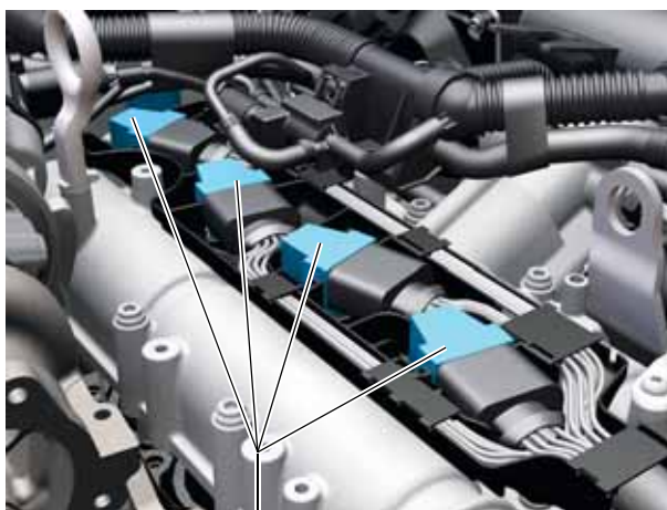
Zündspulen mit Leistungsendstufen N70, N127, N291, N292
