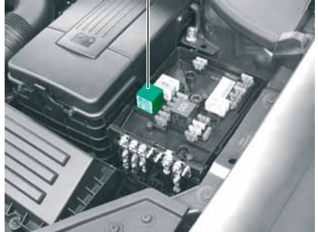
Sensor für Strommessung G582
