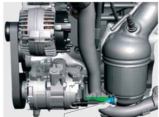
Lambdasonde G130 mit Lambdasondenheizung Z29
