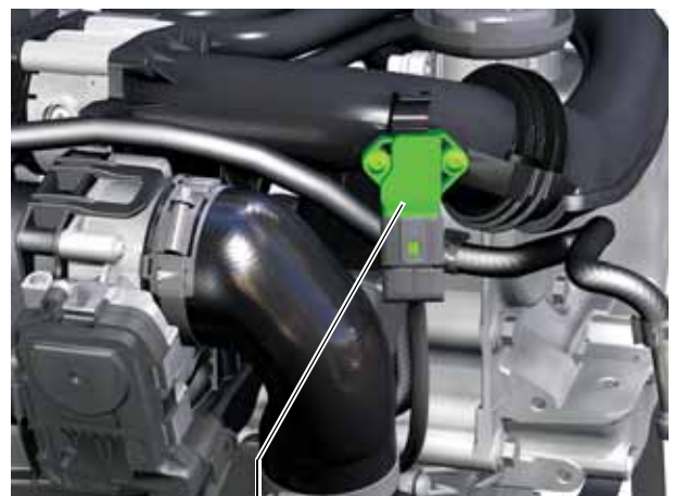
Saugrohrdruckgeber G583 mit Ansauglufttemperaturregeber G520
