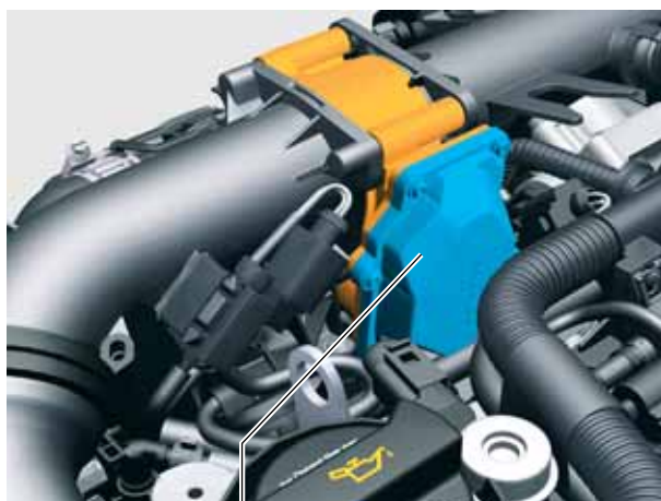
Regelklappen-Steuereinheit J808 mit Stellmotor für Regelklappenverstellung V380
