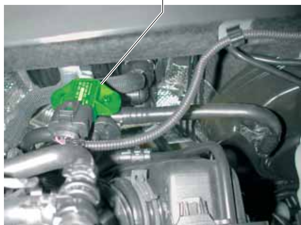
Drucksensor für Bremskraftverstärkung G294
