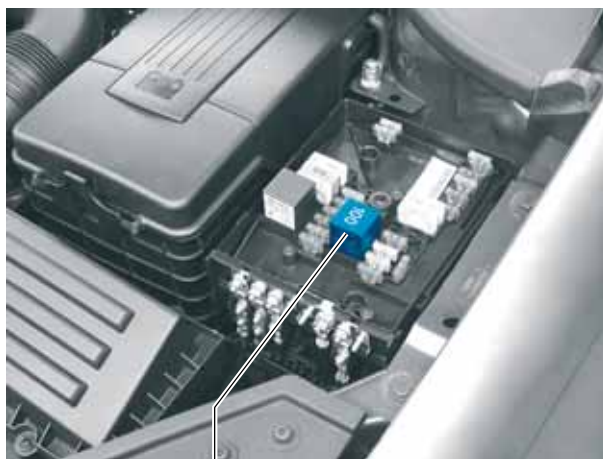
Stromversorgungsrelais für Motronic J271
