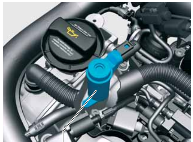
Ventil für Nockenwellenverstellung N205
