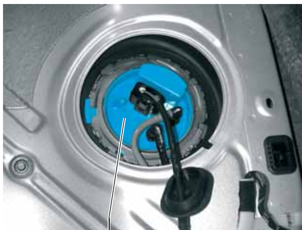
Kraftstoffpumpe G6 S359_076
