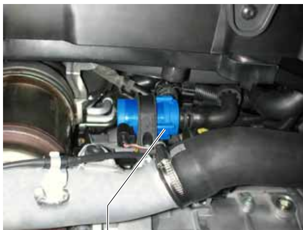
Pumpe für Kühlmittelumlauf V50
