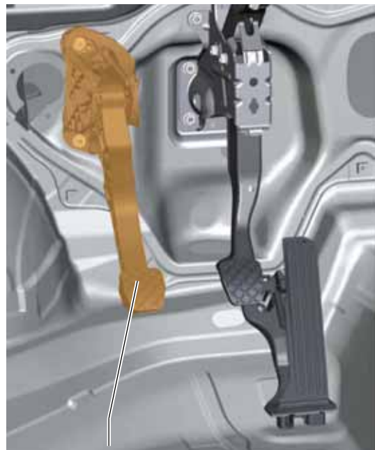
Kupplungspedal mit Kupplungspositionsgeber
