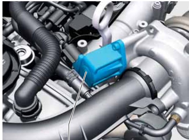
Umluftventil für Turbolader N249
