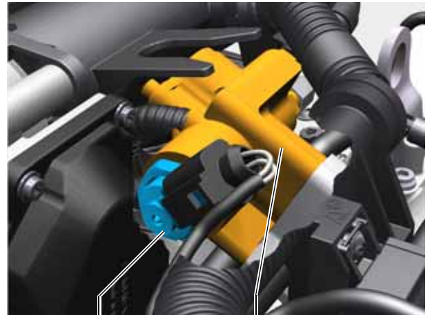
Regelventil für Kraftstoffdruck N276
