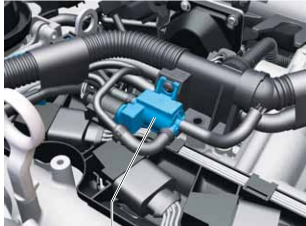
Magnetventil für Ladedruckbegrenzung N75
