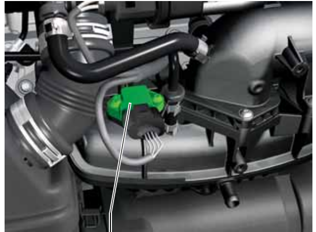
Saugrohrdruckgeber G71 mit Ansauglufttemperaturregeber G42
