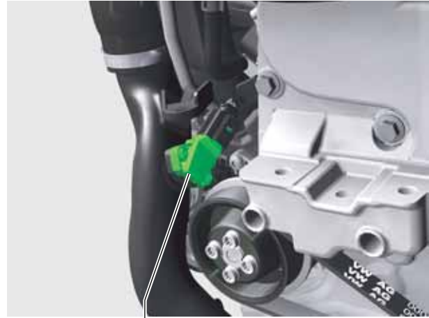
Ladedruckgeber G31 mit Ansauglufttemperaturregeber 2 G299
