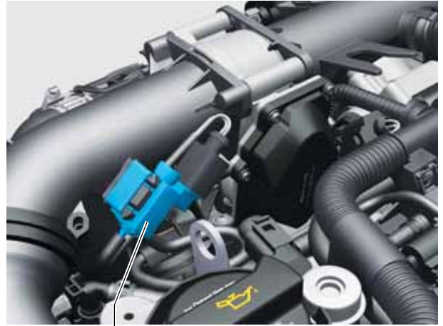
Ventil für Saugrohrklappe N316
