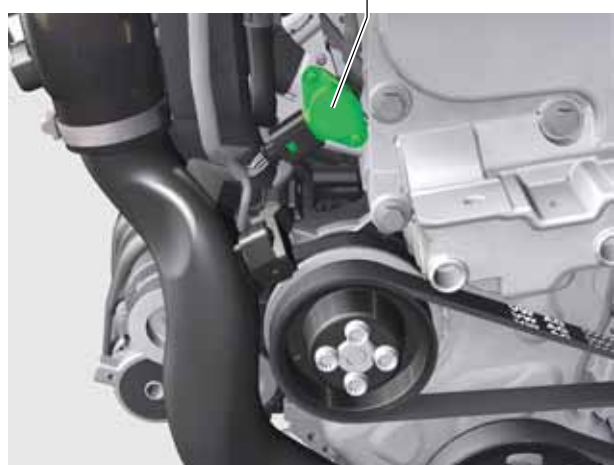
Potenzimeter für Saugrohrklappe G336
