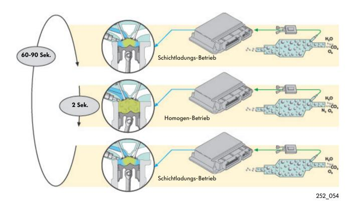
Der NOx-Speicherkatalysator kann im Schichtladungs-Betrieb bis zu 90 Sekunden Stickoxide speichern. Danach erfolgt eine circa 2 Sekunden dauernde Regeneration.
