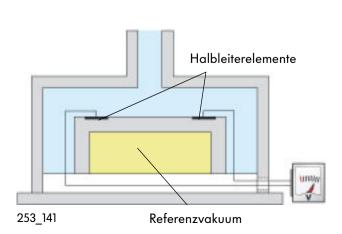
hoher Unterdruck = geringe Ausgangsspannung
