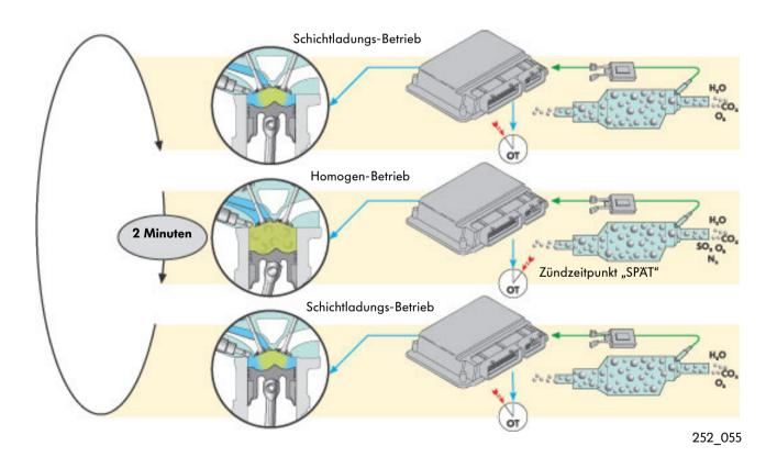
Fahrten mit hoher Last- und Drehzahl führen automatisch zur Entschwefelung, weil dabei im Homogen-Betrieb gefahren und die notwendige Entschwefelungstemperatur im NOx-Speicherkatalysator erreicht wird.
