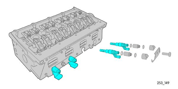
Durch einen Strahlwinkel von 70° und einem Strahlneigungswinkel von 20° ist eine genaue Positionierung des Kraftstoffes, vor allem im Schichtladungs-Betrieb, möglich.
