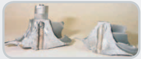
Durch Überdrehzahl geborstenes Verdichterrad
