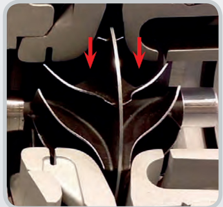
Rote Pfeile: zweiseitiges Verdichterrad
