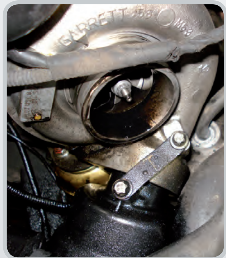
Bild Nr. 4: Öl im Lufttrichter
