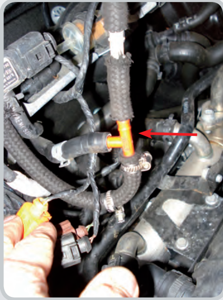
Bild Nr. 18: T-Stück mit Schlauch
