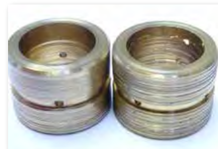
Die tiefen Riefen auf der Innen- und Außenseite des Radiallagers stammen eindeutig von harten Schmutzpartikeln wie Ölkohle und Lagerabrieb.
