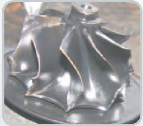
Fremdkörperschaden am Turbinenrad
