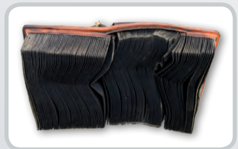
Bild Nr. 20: Verdrehter Luftfilter
