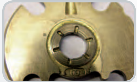
Axialagerverschleiß durch verschmutztes Öl
