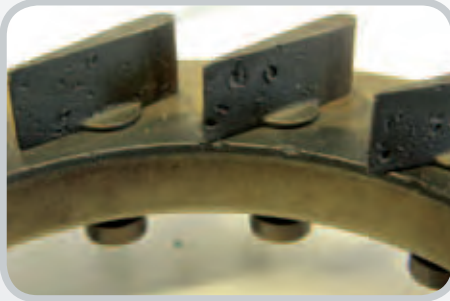
Fremdkörperschaden an den Leitschaufeln der variablen Turbinengeometrie
