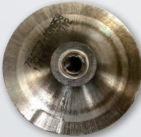
Bild Nr. 2: Strahlenförmiger Ölauftrag auf der Rückseite des Verdichterrades
