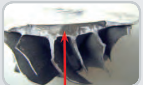
Verdichterrad ist am Radrücken ausgebrochen (Kaltfließstelle)
