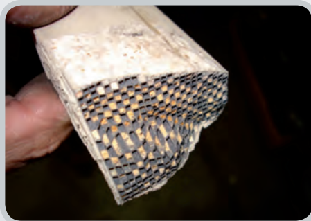
Bild Nr. 16: Verstopfter Partikelfilter
