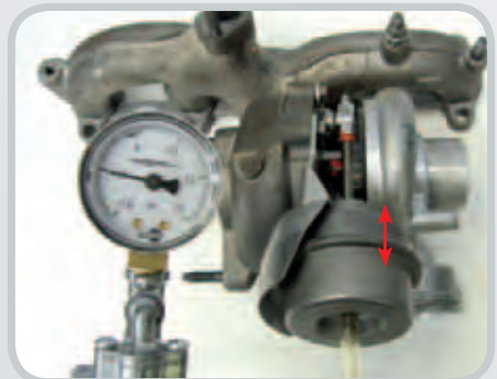
Prüfung der VTG Verstellung
