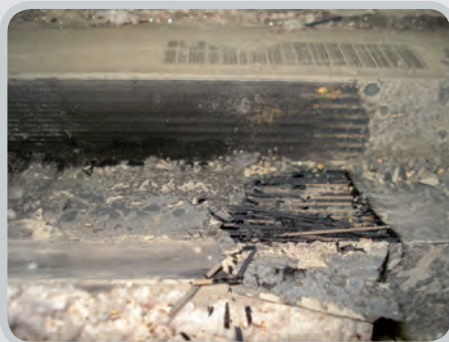
Bild Nr. 17: Komplett verstopfte Kapillaren
