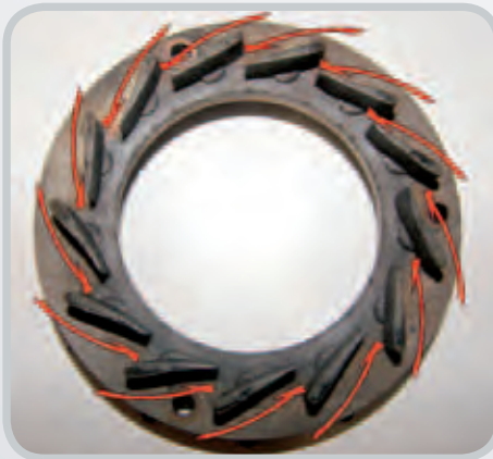
Abgasstromverlauf am Leitring der VTG
