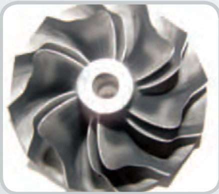
Verdichterradschaden durch Staub, Sand oder Schmutz
