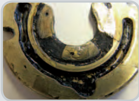
Axiallager mit Ölkohleablagerungen
