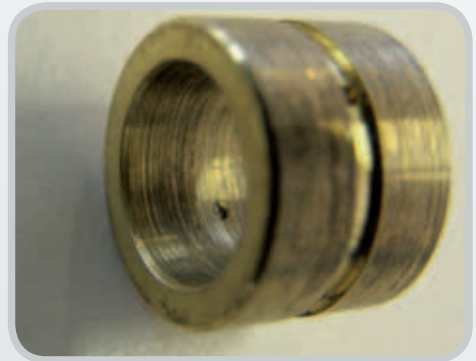
Riefen auf der Radiallagerbuchse durch Schmutzpartikel
