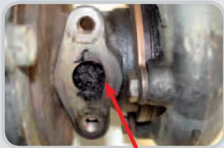
Starker Ölkohleaufbau im Lagergehäuse
