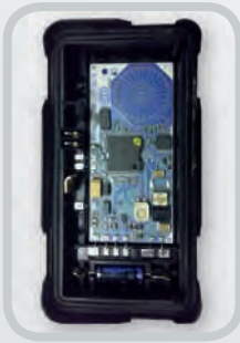
REA – Regelung mit eigenem Prozessor SREA – Regeleinheit
