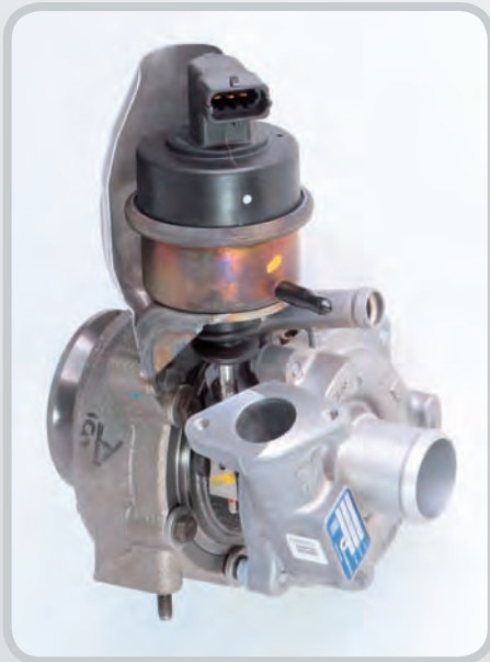
Regeldose mit Positionssensor
