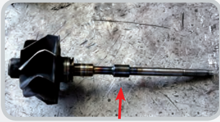
Bild Nr. 40: Thermische Verfärbung
