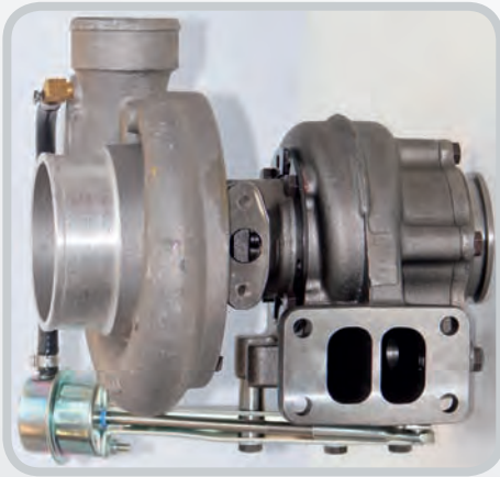
Twin-Scroll – 2 getrennte Abgaskanäle im Turbinengehäuse
