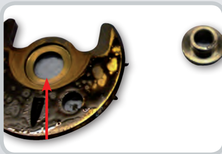
Bild Nr. 9: Starker Verschleiß des Axiallagers
