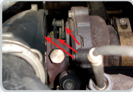
Bild Nr. 8: Abgasaustritt am Turbolader
