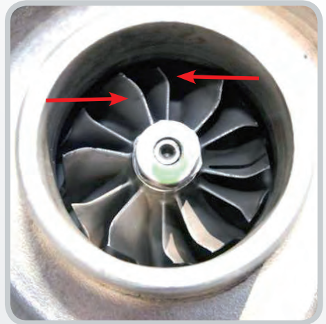
Bild Nr. 22: Durch Ladedruckrückstau verformte Verdichterschaufeln
