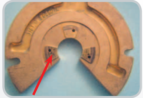
Ölmangelschaden am Axiallager
