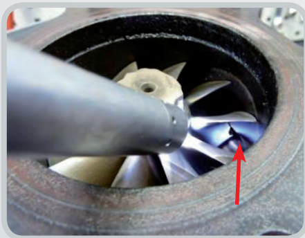
Bild Nr. 41: Ausgerissene und in den Brennraum gelangte Teile
