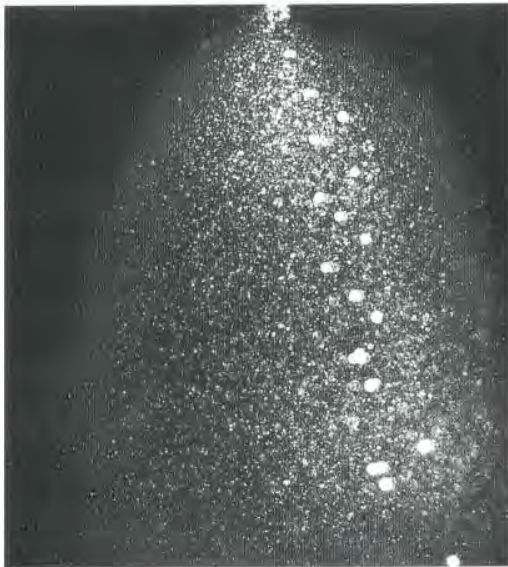
Bild 8: Strahlbilder eines KE-Jetronic-Einspritzventils ohne (links) und mit Luftumfassung. Die Luft wirkt ständig ein und zerstäubt den Kraftstoff noch feiner (rechts).
