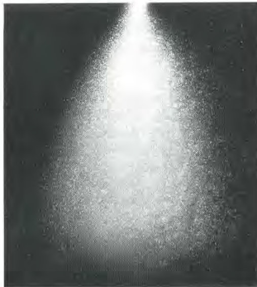
Bild 8: Strahlbilder eines KE-Jetronic-Einspritzventils ohne (links) und mit Luftumfassung. Die Luft wirkt ständig ein und zerstäubt den Kraftstoff noch feiner (rechts).
