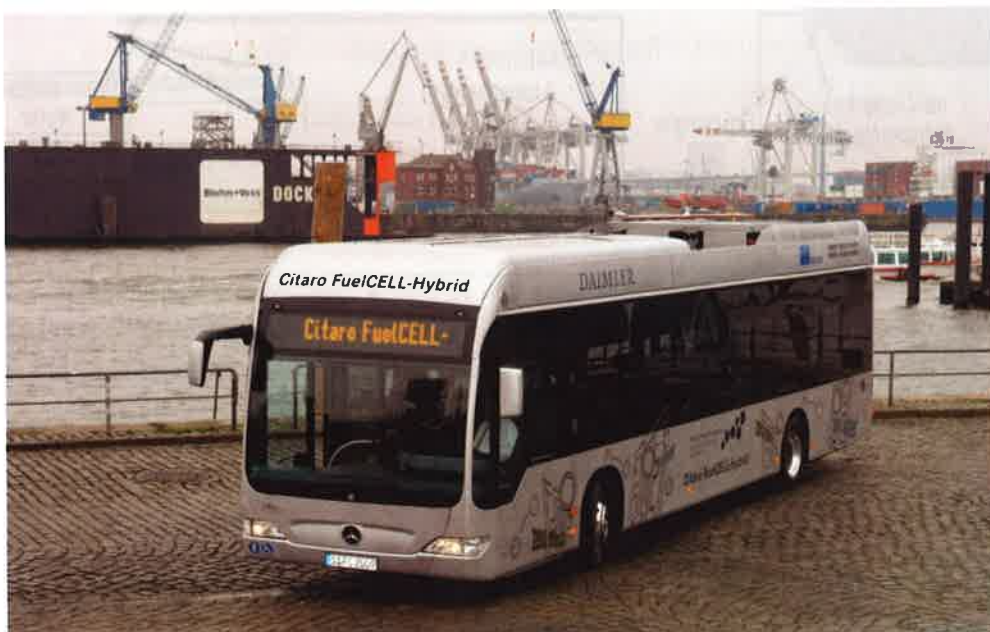
Abbildung 4-18: Omnibus mit Wasserstoffantrieb Citaro FuelCELL (Quelle: Daimler AG)
