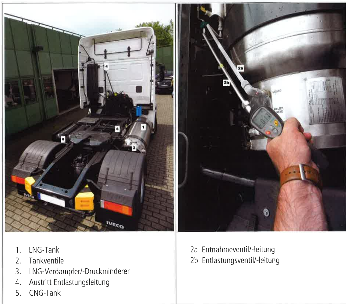
Abbildung 4-5: LNG-Fahrzeug IVECO Stralis
