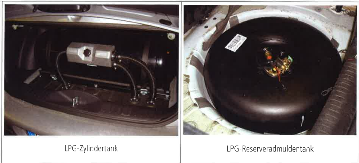
Abbildung 4-8: Ausführungsvarianten von LPG-Behältern
