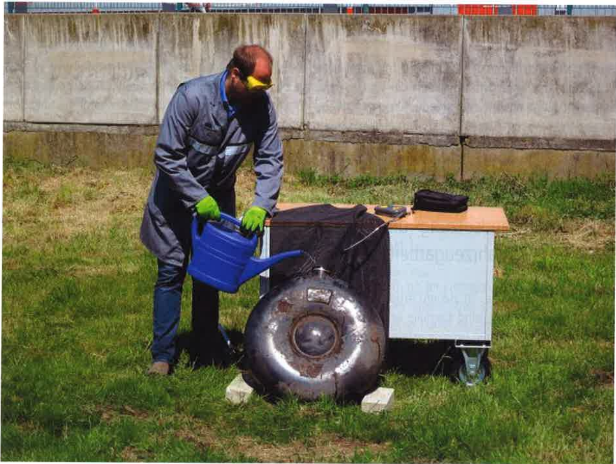
Abbildung 5-4: Vollständige Entleerung eines LPG-Tankbehälters
