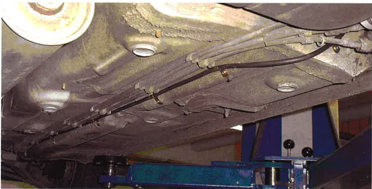
Abbildung 4-12: Ummantelte LPG-Kupferleitung am Unterboden eines Kraftfahrzeugs ohne gasdichtes Gehäuse
