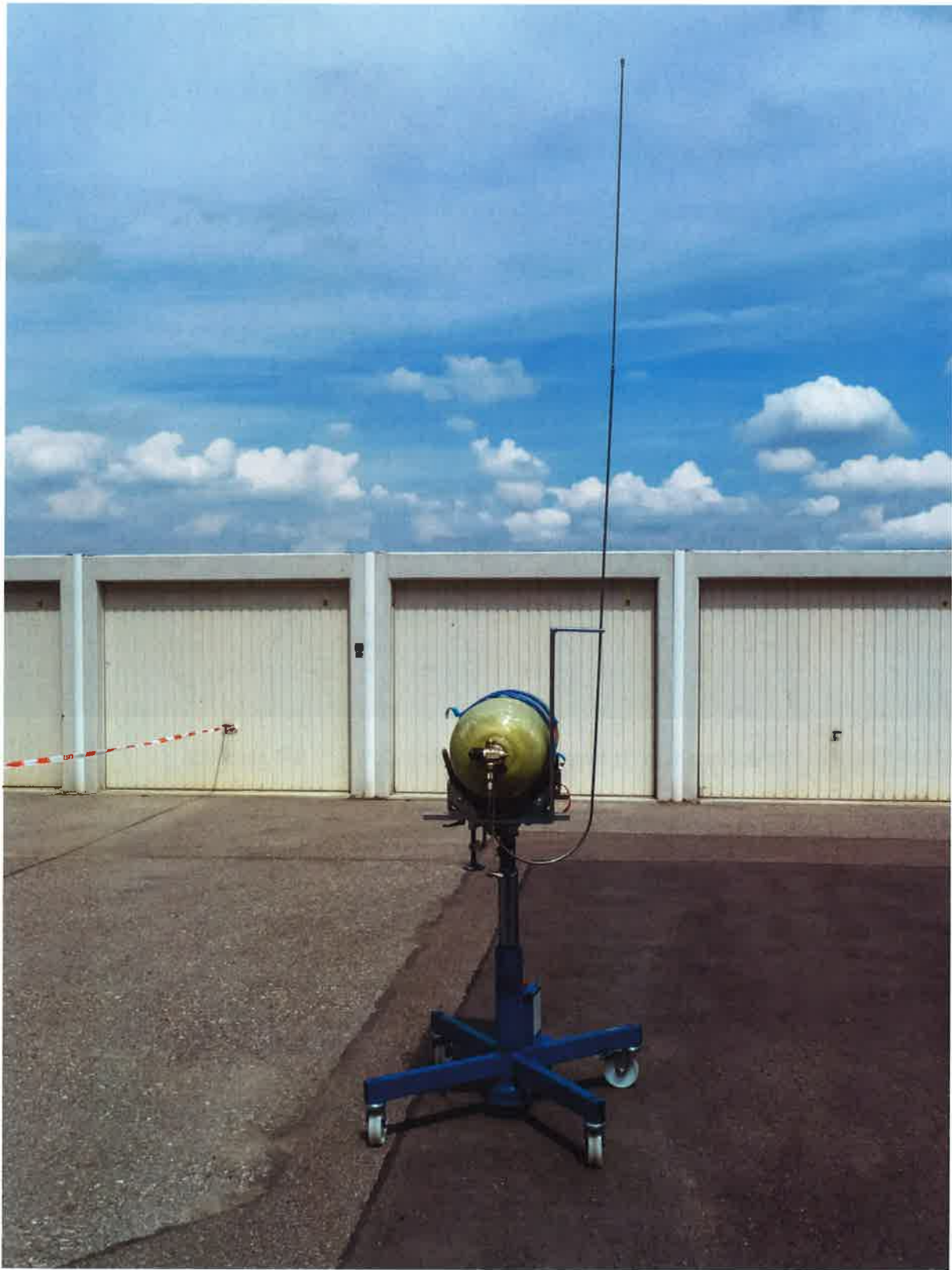
Abbildung 5-3: Vom Volkswagenkonzern empfohlene Vorrichtung zum Entspannen von CNG-Tanks. Für das Ablasen ist ein Sicherheitsbereich (10 m Radius) abzugrenzen.
