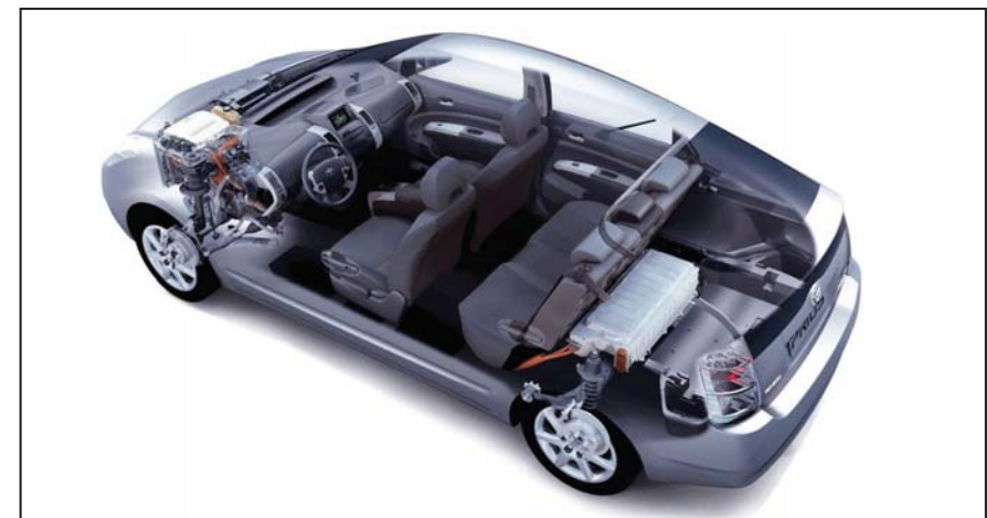
Bild 24: Aufbau des Hybridantriebsystems im Toyota Prius II; Quelle: Toyota
