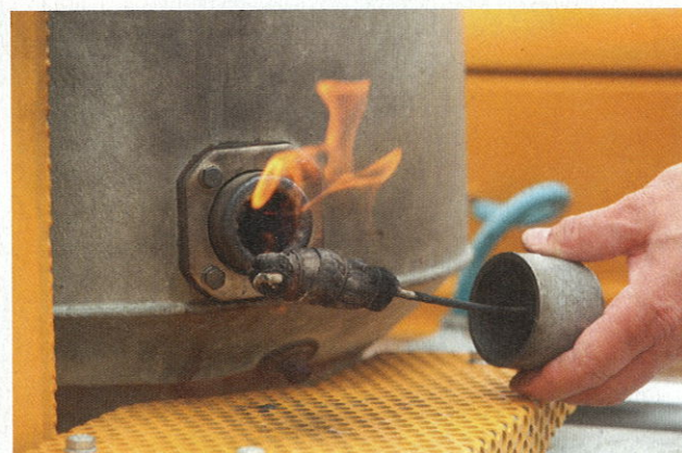
Der Gaserzeuger wird mit einer Lunte angefeuert.
