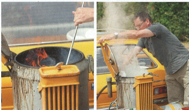
...und die Reise kann weitergehen. Bis ans Ziel. Wartungsarbeiten gibt es je nach Betriebsstunden. Russ zum Beispiel muss – frühestens 24 Stunden nach der letzten Fahrt – aus dem Herd gekratzt werden, und Filter sollten mit Wasser gereinigt und dann, um Rost vorzubeugen, vollständig ausgetrocknet werden.
