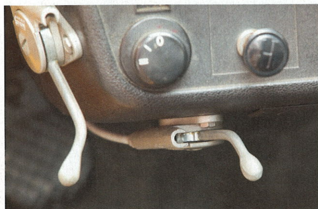
Über zwei Bowdenzüge wird beim Gasbetrieb das Gemisch sauber eingestellt.
