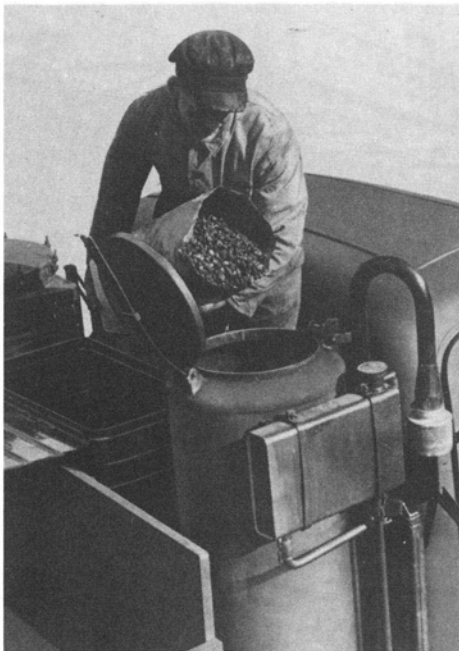
6 Nicht eben angenehm war die Handhabung der Generatoren. Unbeliebt war vor allem die Reinigung der Anlage, aber auch das Beschicken mit Brennstoff, von Herstellern und Staat mit »Tanken« heruntergespielt. Füllen eines Daimler-Benz-Kohle-Gaserzeugers, Lizenz Gobin-Poulenc 1941.
