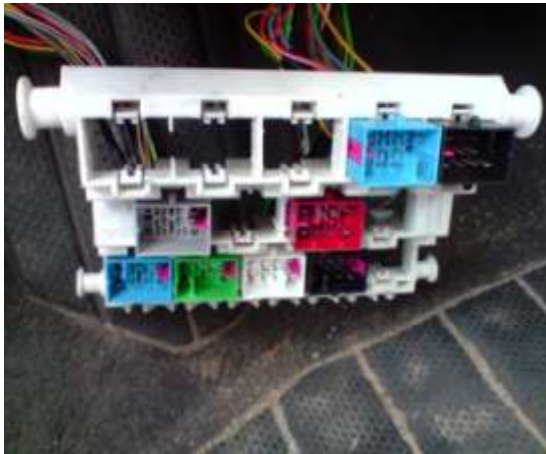
Kupplungsstation unter dem Relaisträger
