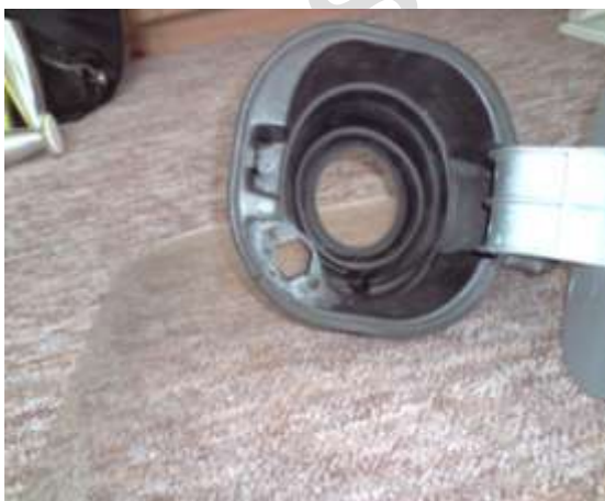
Tankstutzen mit Füllanschlusssaufnahme:
