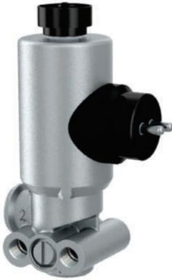
Dieses Ventil wird bestromt, um bei unterschiedlichen Radgeschwindigkeiten ein Rad einbremsen zu können. Es lässt den Vorratsdruck weiter zu den ABS-Regelventilen. Über die Regelventile kann dann auf der richtigen Seite der nötige Druck angesteuert werden.
